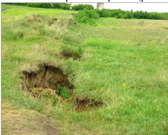
Рис.9. Суффозионные провалы вдоль трещины закола оползня в с. Усть-Чарышская Пристань, Алтайский край (Алтайский ТЦ ГМСН)
