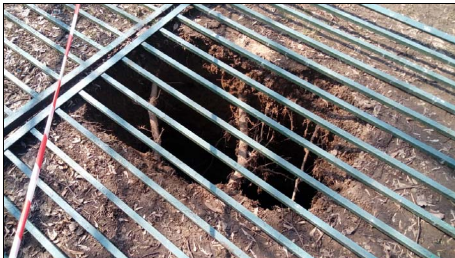
Рис. 2. Суффозионный провал на территории дошкольного отделения школы № 626, г. Москва (ТЦ ГМСН по г. Москва)
