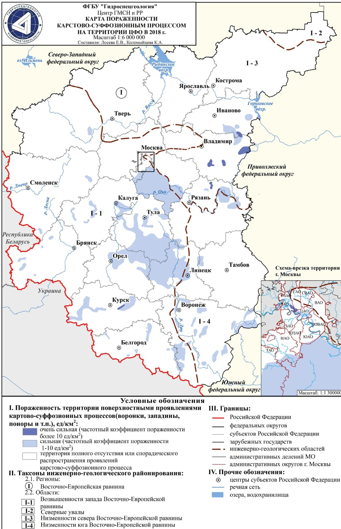
**Рис. 2.2 Карта поражённости территории ЦФО карсто-суффозионным процессом (по состоянию на 01.01.2019 г.)**
