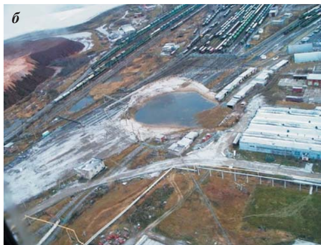
Рис. 2.50. Провал №2 на железнодорожных путях по состоянию на 26.04.2012 г. (а) и 01.11.2012 г. (б), Пермский край (Верхнекамский центр МГС ОАО “Уралкалий”)
