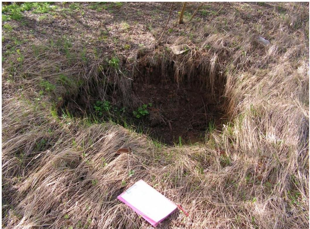
Фото 18-17-00003. Суффозия. Участок дежурных инженерно-геологических обследований «Крымская Слудка», Кизнерский район, Удмуртская Республика. Апрель 2024 г. Суффозионный провал
