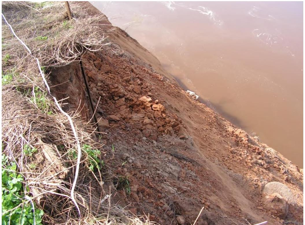
Фото 18-11-00021. Оползневой процесс. Участок дежурных инженерно-геологических обследований «Крымская Слудка», Кизнерский район, Удмуртская Республика. Апрель 2024 г. Оползень вязкопластического течения в т.н.2
