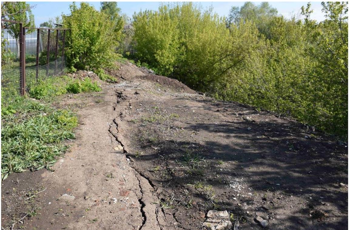
Фото 16-11-00006 Свежие трещины отрыва на левом борту оврага Ржавец по ул. Фрунзе, г. Чистополь, Чистопольский район, Республика Татарстан
