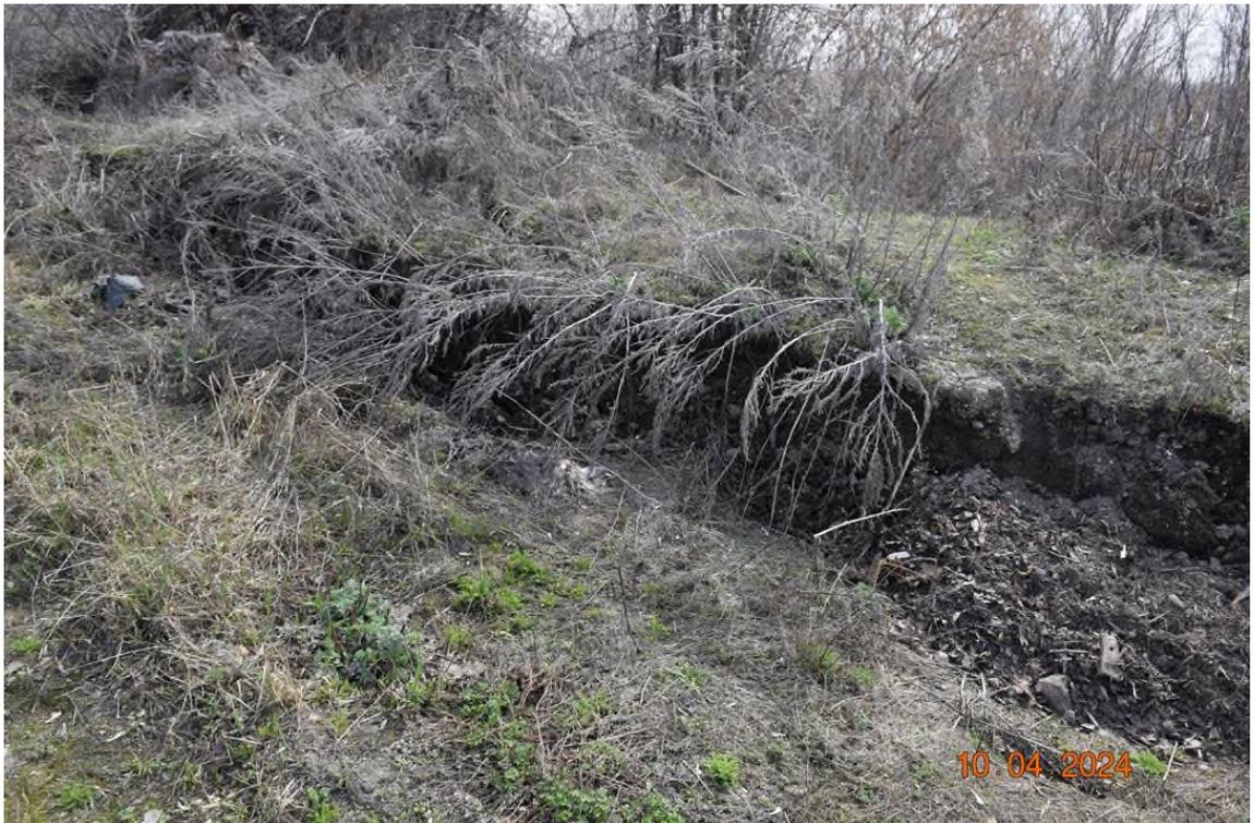
Фото 64-11-00052 Трещина с вертикальным смещением в 16 м от дома № 8 улицы Коржевина, г. Вольск, Саратовская область
