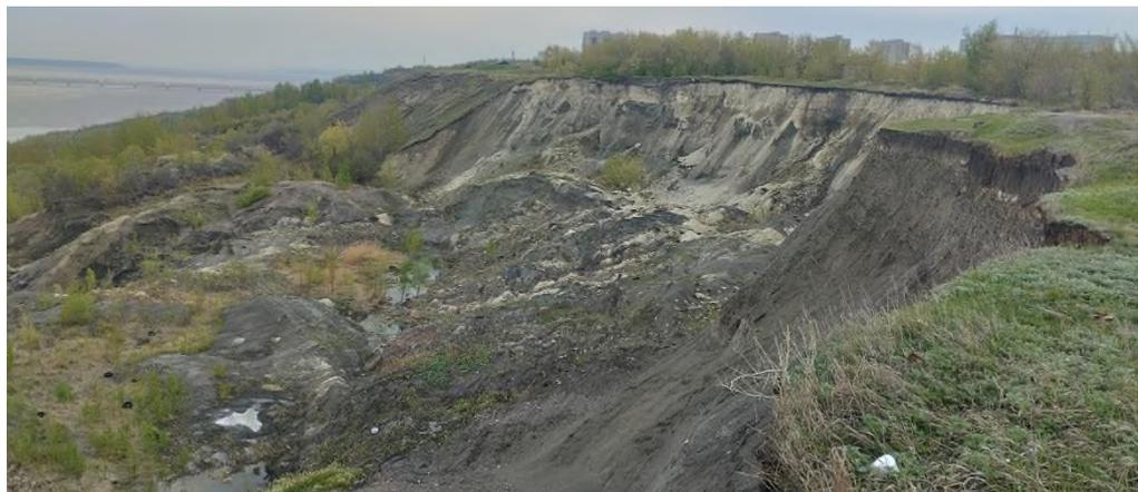
Фото 73-11-00002. Общий вид оползневого смещения, оползневые срывы, уступы, застои грунтовых вод Ульяновская область, г. Ульяновск, Ленинский р-н. ул. Мостостроителей
