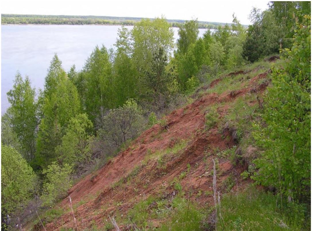
Фото 18-11-00007. Оползневой процесс. Участок дежурных инженерно-геологических обследований «Сухарево», Каракулинский район, Удмуртская Республика. Май 2024 г. Оползень вязкопластического течения в т.н. 3.
