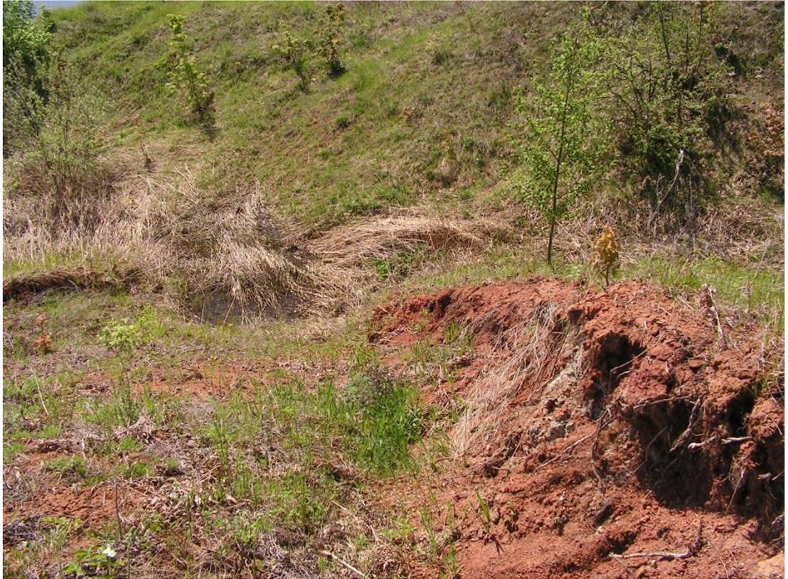
Фото 18-11-00012. Оползневой процесс. Участок дежурных инженерно-геологических обследований «Чеганда», Каракулинский район, Удмуртская Республика. Май 2024 г. Оползневая трещина сдвига в т.н.3.
