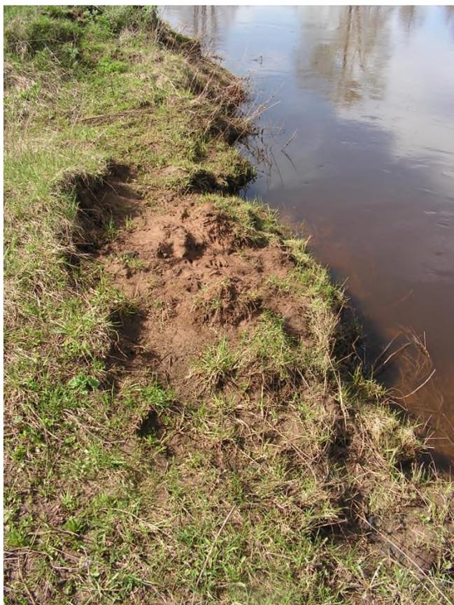
Фото 18-11-00018. Оползневой процесс. Участок дежурных инженерно-геологических обследований «Нылга», Увинский район, Удмуртская Республика. Апрель 2024 г. Оползневая трещина сдвига на правом береговом уступе р. Нылга в т.н. 2.
