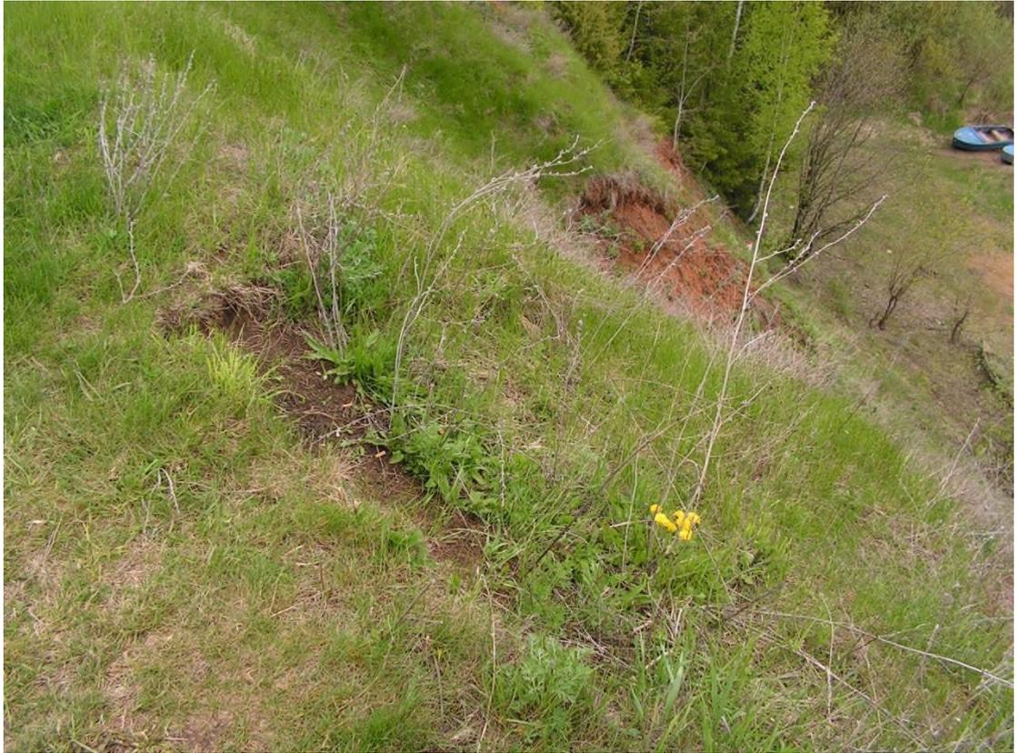
Фото 18-11-00016. Оползневой процесс. Участок дежурных инженерно-геологических обследований «Гольяны», Завьяловский район, Удмуртская Республика. Май 2024 г. Оползневая трещина сдвига в т.н. 7
