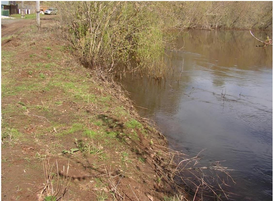
Фото 18-11-00017. Оползневой процесс. Участок дежурных инженерно-геологических обследований «Нылга», Увинский район, Удмуртская Республика. Апрель 2024 г. . Оползень вязкопластического течения в т. н.1
