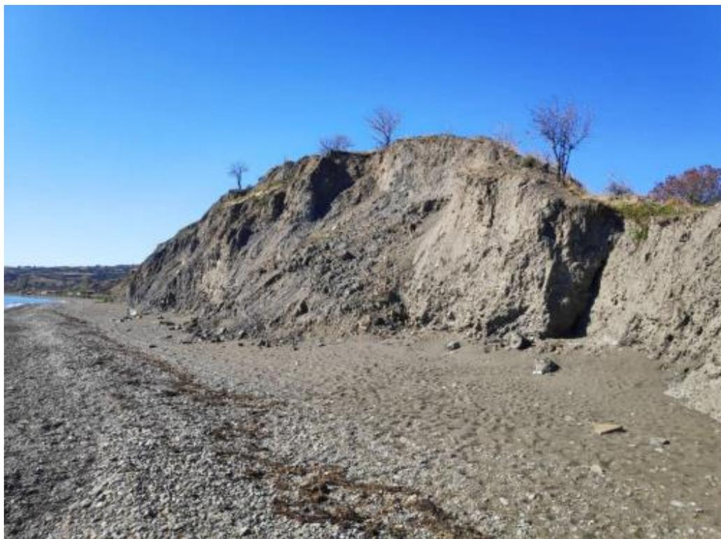
Фото 20. Проявление 91-11-05701. Оползень № 750, языковая часть подверженная морской абразии, активная зона ОЭГП. Вид со стороны пляжа, левый борт.
