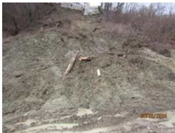
Фото 23.11.00189. Активизация оползневой процесса в г.Туапсе в районе улиц Кириченко и Калараша. Фото ЮРЦ ГМСН «Гидроспецгеология»
