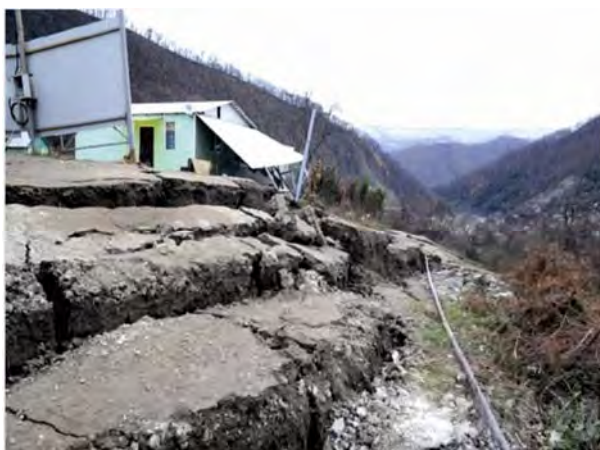
Рис.5. Формирование активных уступов смещения оползневого массива в районе с. Барановка (ГУП «Кубаньгеология»)
