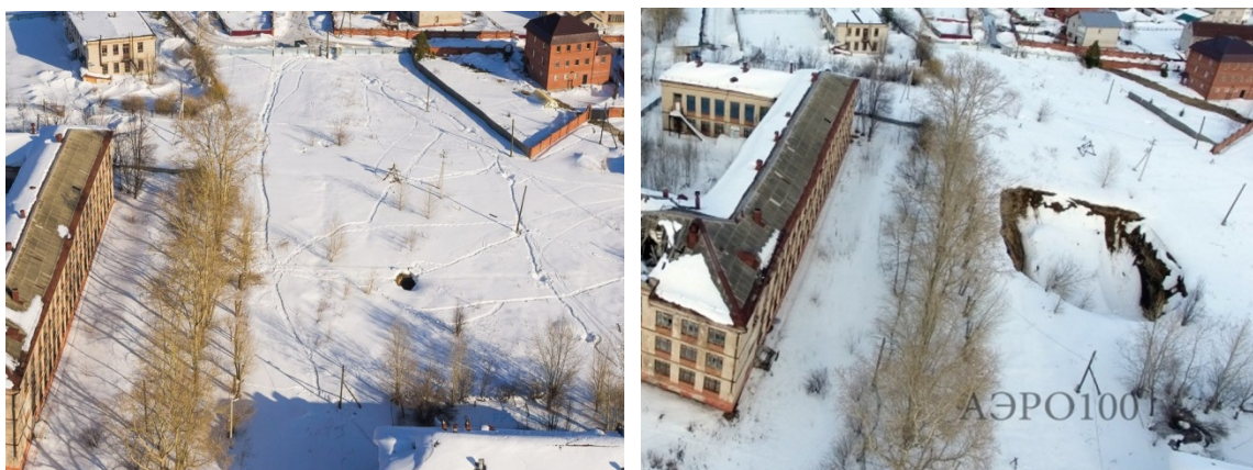
Рис. 7 Провал №4 на БКПРУ-1 на момент образования (слева) и по состоянию на март 2017 г. (справа). Пермский край, г. Березники (ТЦ ГМСН по Пермскому краю).
