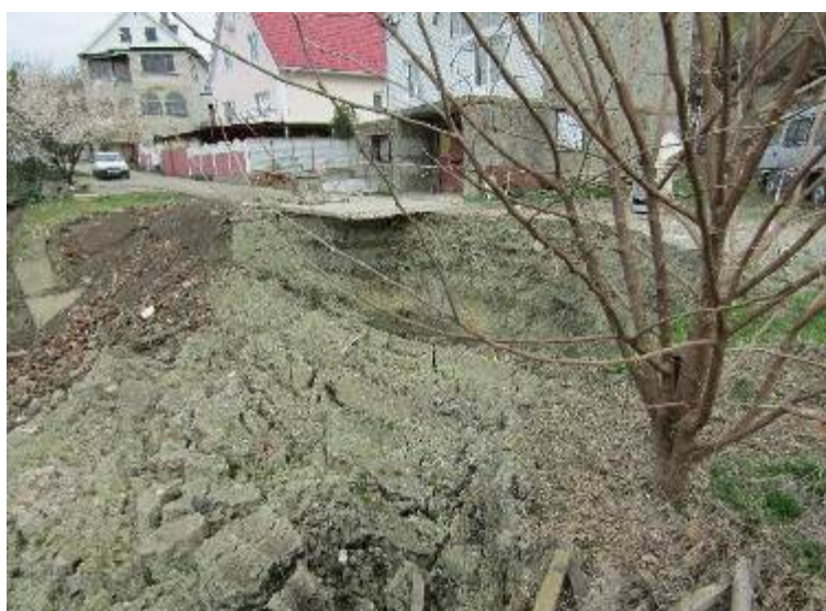
Рис. 6 Головная часть оползня. Высота стенки срыва – 3,2 м, ширина оползня – 18 м. Краснодарский край.
