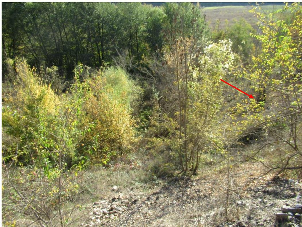
Фото 91.2021.00024. Свежий срыв в головной части оползня высотой до 2,0 м.
