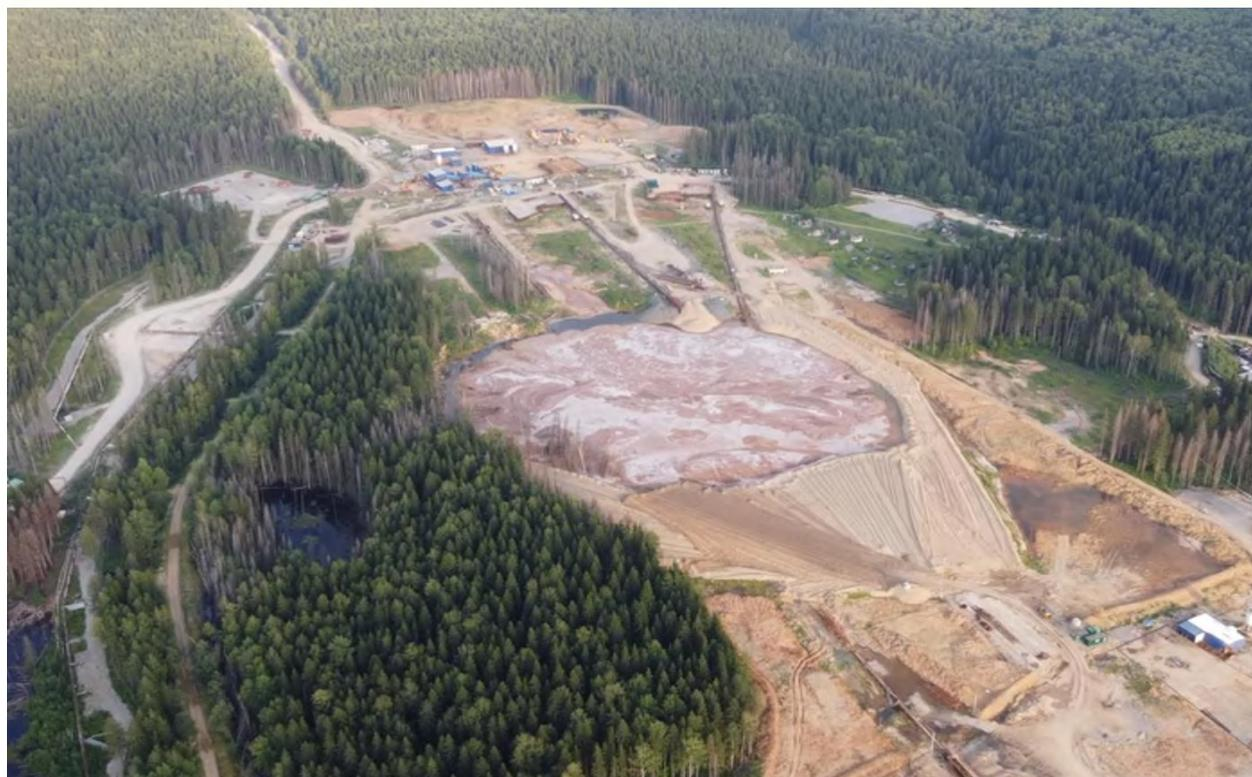
Фото 59.2021.0002. Провал на аварийном участке СКРУ-2, СНТ «Ключики», г. Соликамск, июль 2021 г. Пермский край
