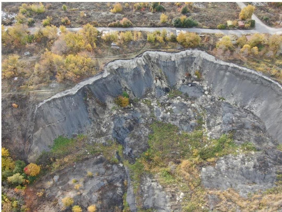
Фото 73.2021.0009. Срывы грунта, осыпи, застои грунтовых вод на оползне 2. Ленинский район, ул. Мостостроителей, г. Ульяновск, Ульяновская область
