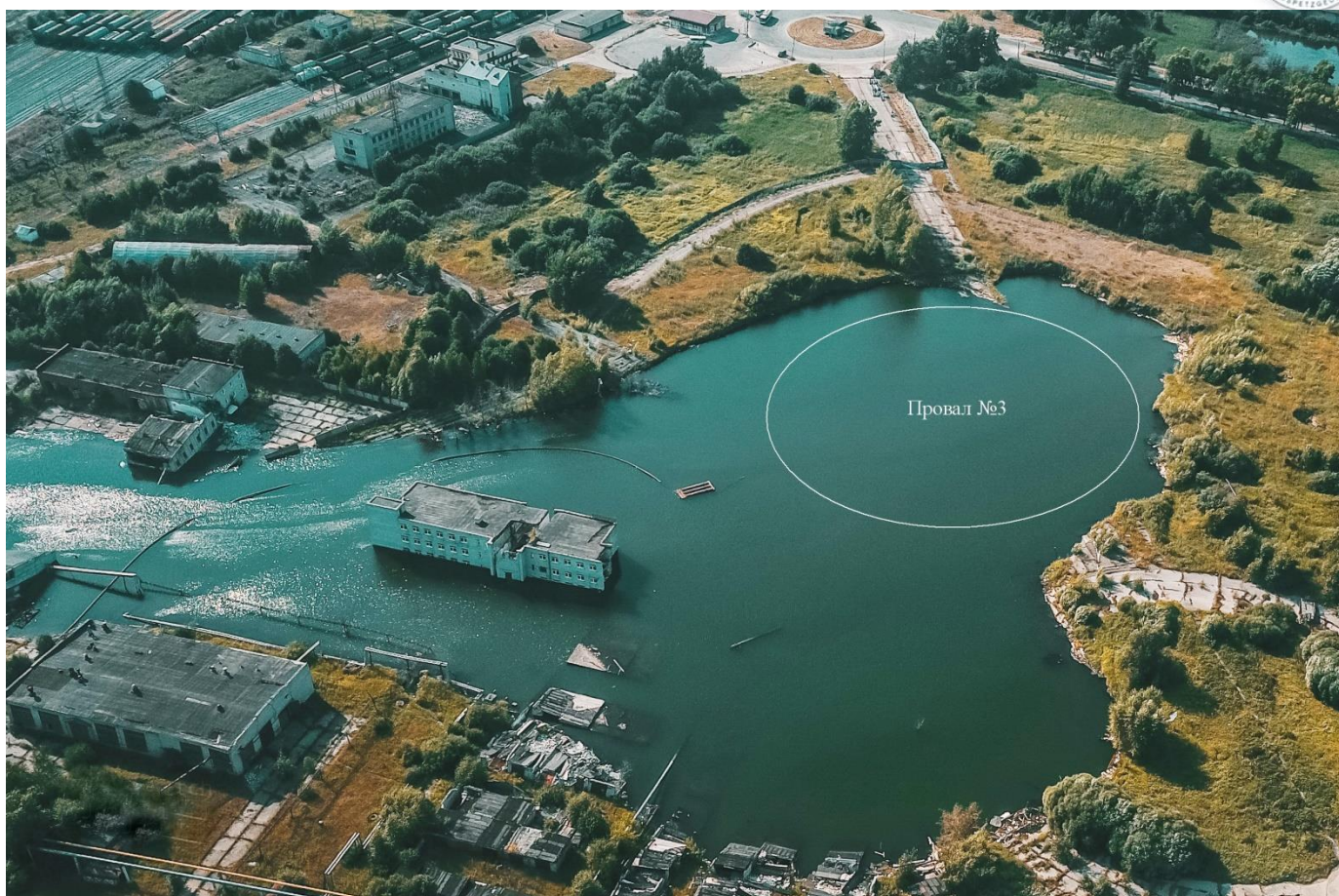
Фото 59.2022.0001. Провал №3, опускающиеся под воду гаражи в ГК «Кардан» и автодорожное кольцо (справа внизу), г. Берзники, июль 2021 г. Пермский край.
