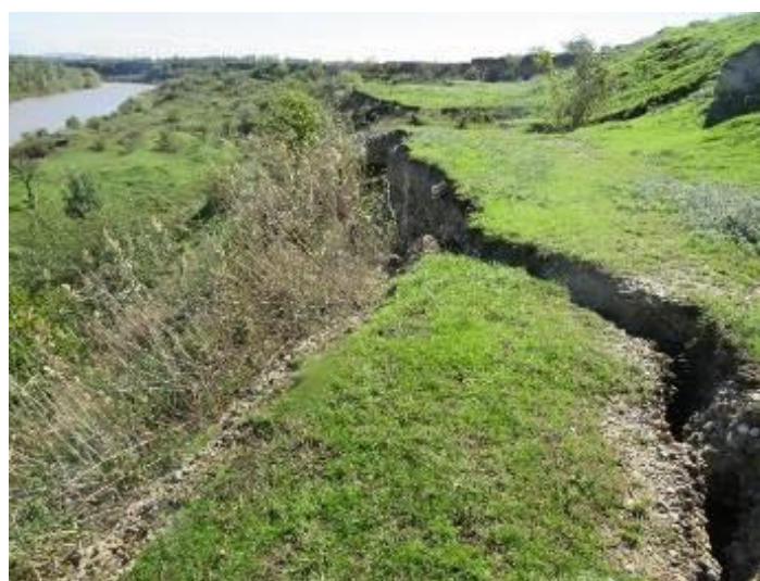
Фото 26.2022.0058. Оп. №1641. Блоковые смещения на локальном участке в левой части оползня, Юго-восточная окраина с.Кочубеевского, Ставропольский край
