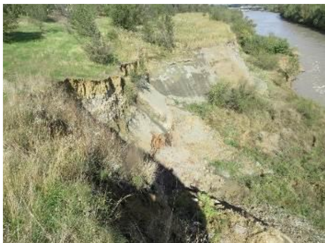
Фото 26.2022.0056. Оп. №2994. Смещения средней интенсивности локальных участках в левой половине оползня, Кочубеевский МО, Ставропольский край
