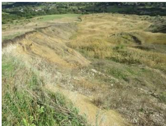
Фото 26.2022.0060. Оп. №2303. Смещения минимальной интенсивности в отложениях у осыпающегося откоса и голове, Западная окраина х. Васильевского Кочубеевского МО, Ставропольский край
