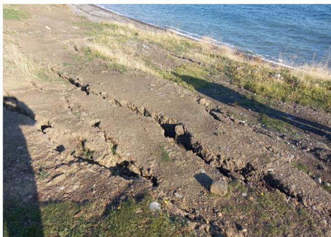
Фото 91-10-05801. Трещины закола в восточном левом борте оползня. г.о. Судак, с. Морское
