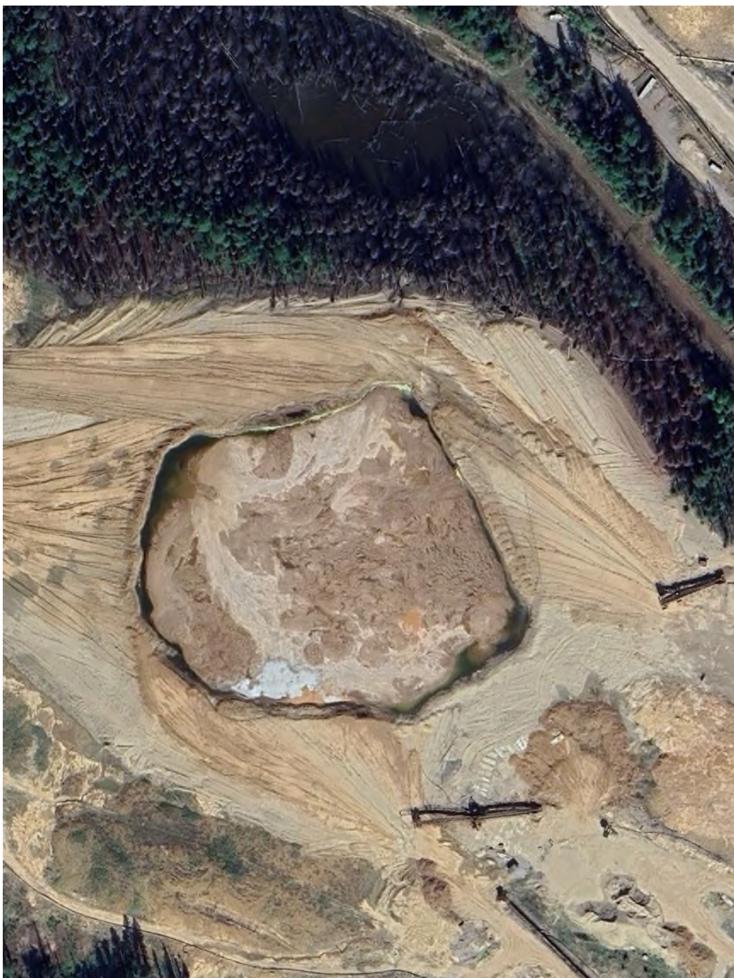
Фото 59-26-00010. Провал на аварийном участке СКРУ-2, июнь 2024 г., СНТ «Ключики», г. Соликамск
