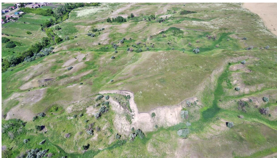
Фото 73-11-00127. Срывы и осыпи грунта в районе бровки оползня Ульяновская обл. Сенгилеевский р-н, с. Выростайкино
