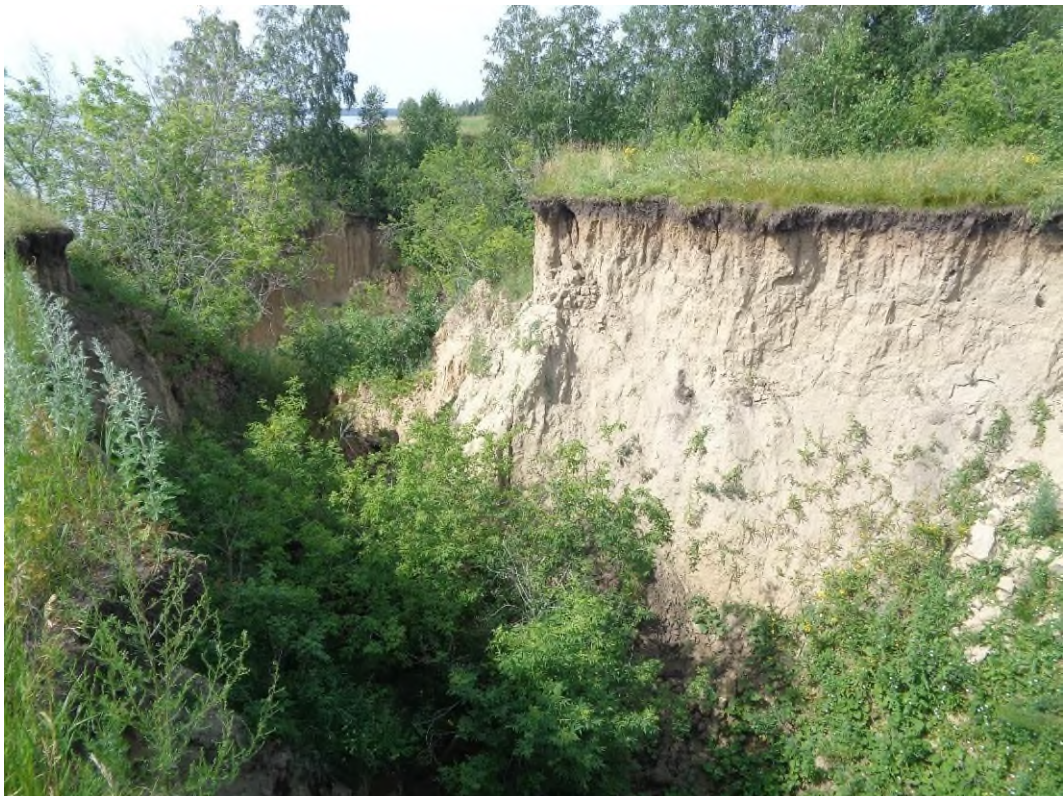
Фото 54-22-00022. Овраг № 13 устье-левый борт. Бровки бортов выражены отчетливо. Борты сверху обрывистые, 4-7 м. Склон их неустойчив, много столбчатых отслоений. Ниже – осыпи, оползни с уклоном 60-80°. с. Ленинское, Новосибирский район, Новосибирская область, 18.07.2024
