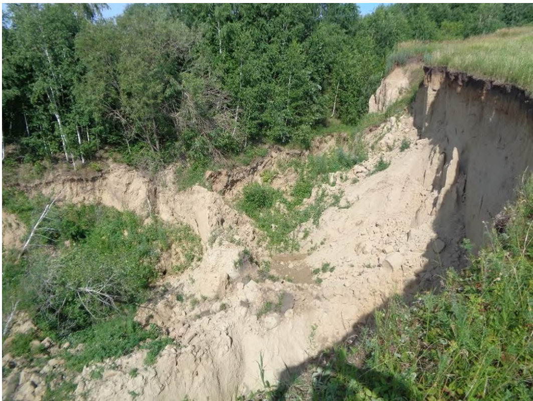
Фото 54-22-00019. Овраг № 10 устье-левый борт. Склоны левого борта вертикальные с отслоением грунта в виде глыб столбчатой структуры. Бровка борта выражена отчетливо. Обнажены светло-коричневые лёссовидные суглинки-супеси. с. Ленинское, Новосибирский район, Новосибирская область, 18.07.2024
