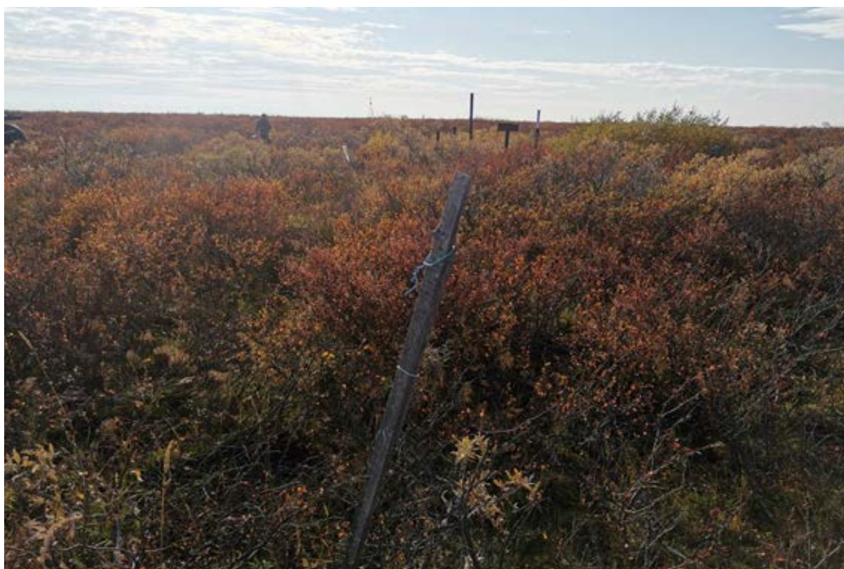
Фото 92. Пучиномерный створ. Створ геодезических измерений, МО ГО "Воркута", Воркутинский опорный мерзлотно-гидрогеологический полигон, участок детальных наблюдений Лек-Воркутский 1
