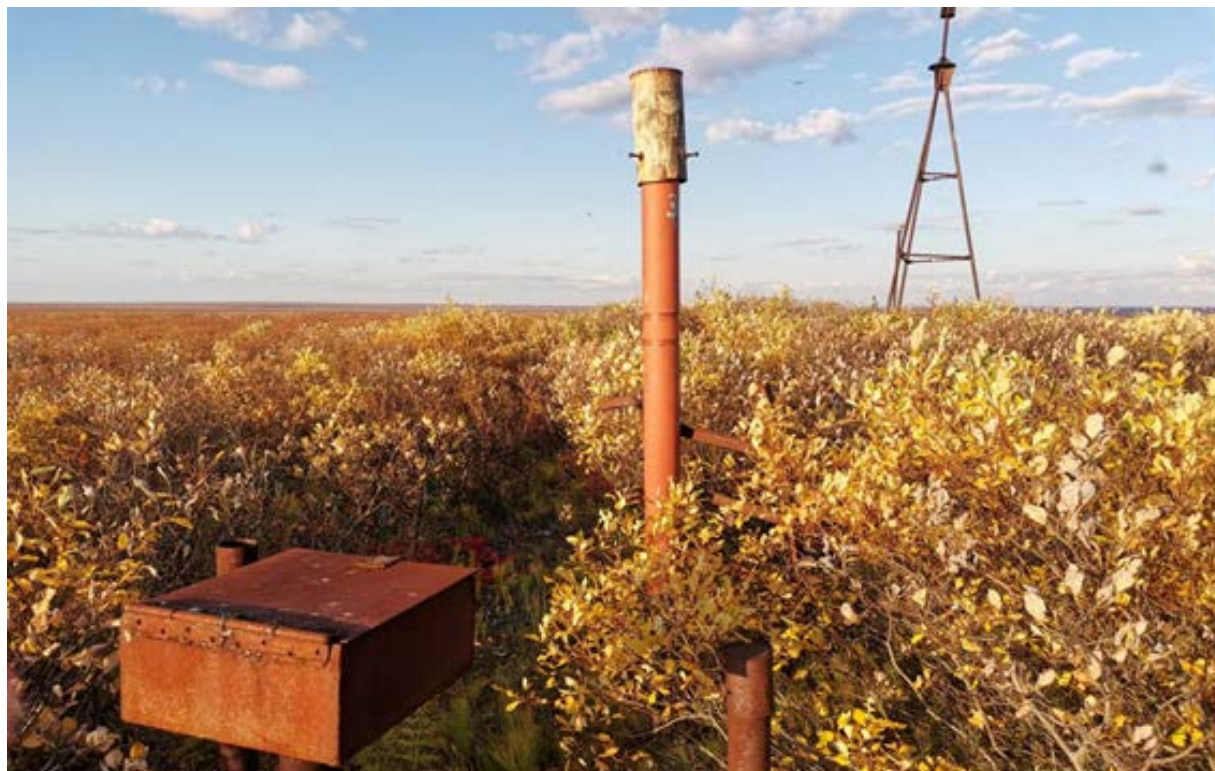
Фото 89. Скважина термометрическая, МО ГО "Воркута" (ЗС-115), Воркутинский опорный мерзлотно-гидрогеологический полигон, участок детальных наблюдений Лек-Воркутский 1
