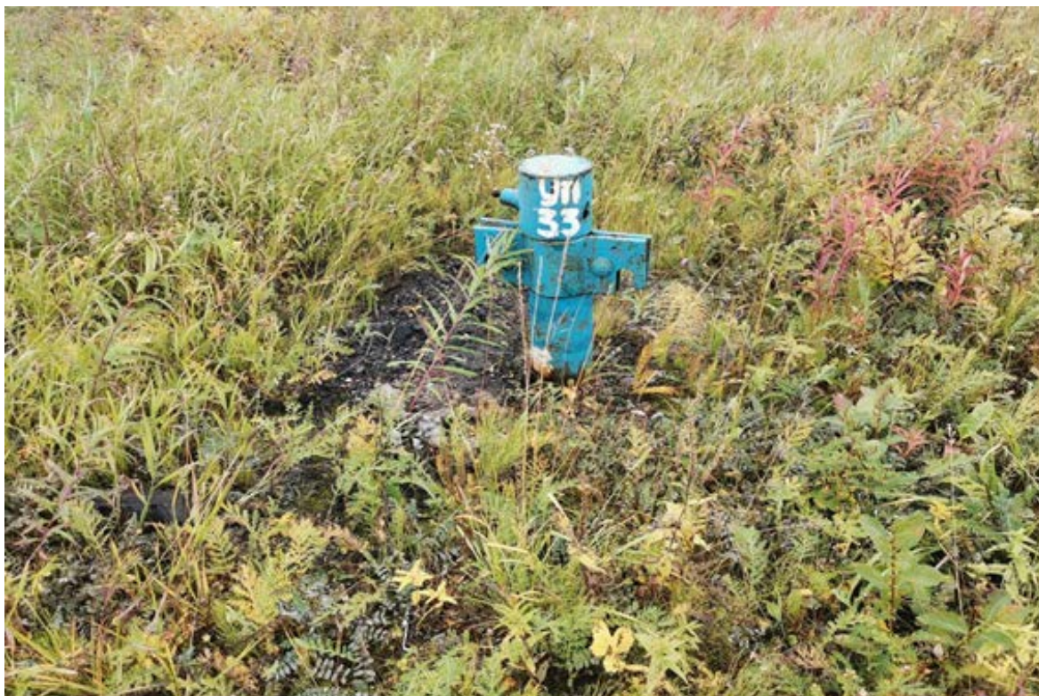
Фото 97. Скважина термометрическая, МО ГО "Воркута" (УП-33), Воркутинский опорный мерзлотно-гидрогеологический полигон, участок детальных наблюдений Усинское водохранилище 1
