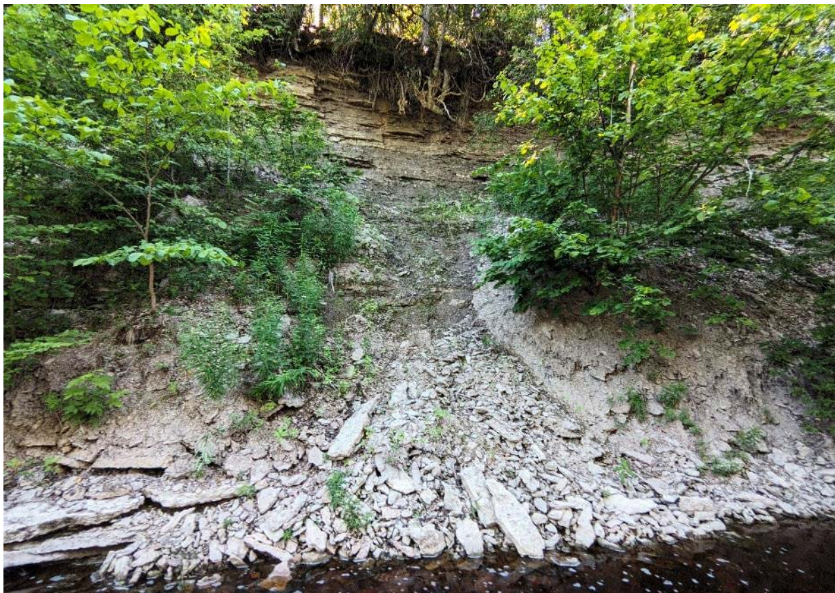
Фото 60. Обвальный процесс с элементами эрозии на береговом склоне, промоина с делювиально-коллювиальными отложениями.
