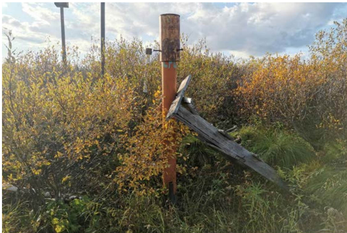
Фото 90. Скважина термометрическая, МО ГО "Воркута" (ЗС-83а), Воркутинский опорный мерзлотно-гидрогеологический полигон, участок детальных наблюдений Лек-Воркутский 1
