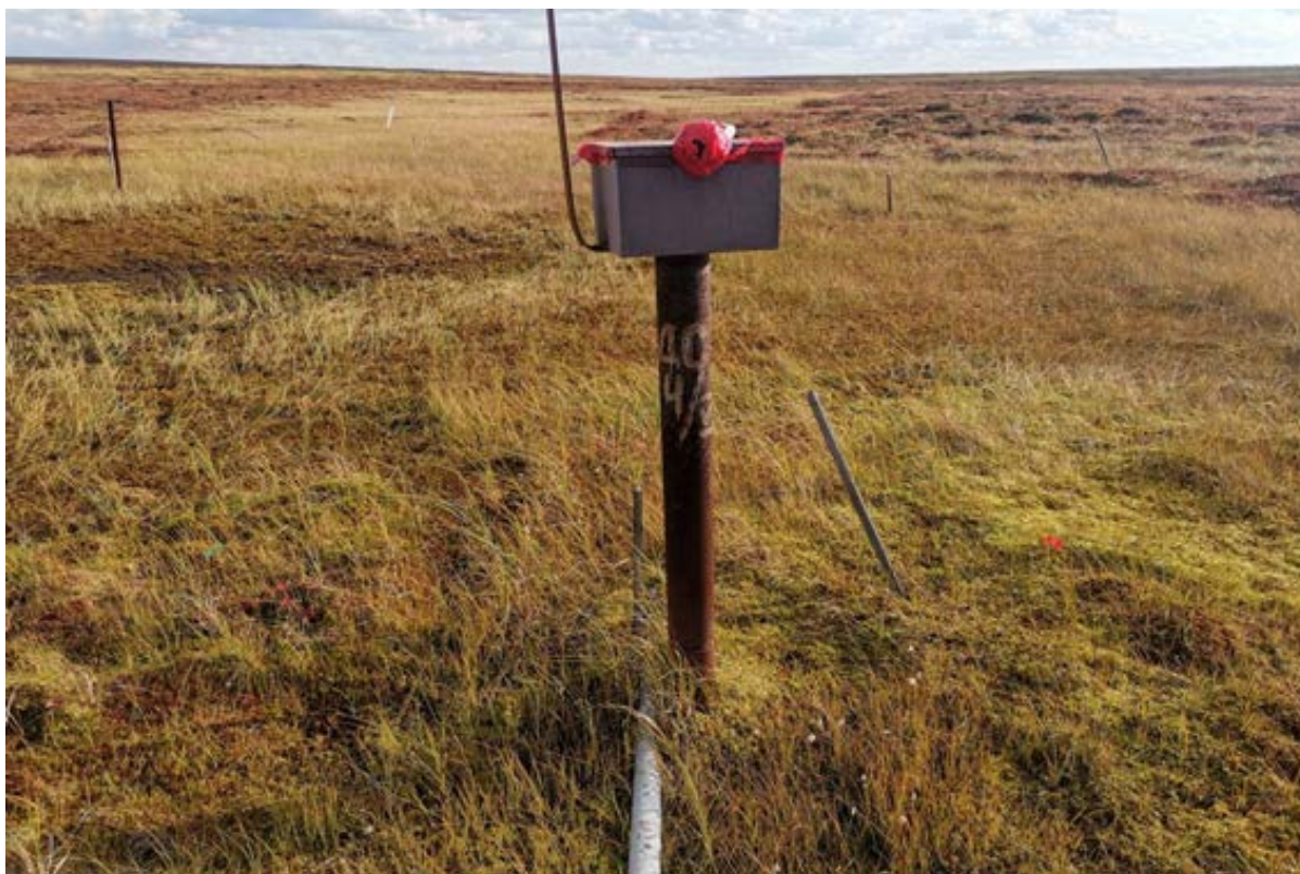
Фото 85. Скважина термометрическая, МО ГО "Воркута" (ДС-4/VI-74), Воркутинский опорный мерзлотно-гидрогеологический полигон, участок детальных наблюдений МГП 2
