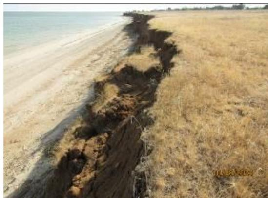
Фото 34-10-00023. Обвальный берег напротив восточной части ст-цы Нагавской Котельниковского района. Ширина зоны обвального уступа составила 3,24 м. (Фото филиала ЮРЦ ГМСН ФГБУ «Гидроспецгеология»)
