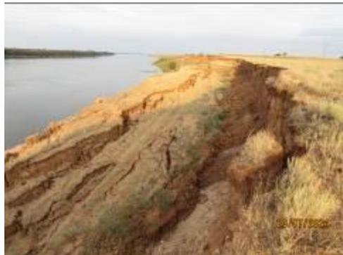
Фото 30-11-00005. Разрушение оползневой ступени в западной части оползневого проявления Пришиб Енотаевского р-на.
