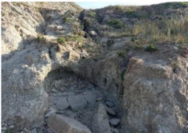
Фото 19. Оползень № 1836, нижняя западная часть. Разгрузка на пляж эрозионной промоины на низовом примыкании к грунтовому проезду. Инструментальный замер. Глубина оврага 1,49 м (не изменилась). Эрозионно-суффозионный размыв и оползание в месте разгрузки оврага на пляж. Проявление опасного ЭГП № 91-11-06403.
