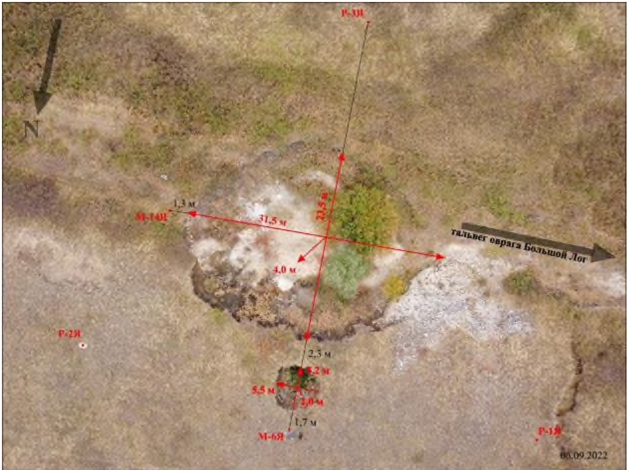
Фото 74-31-00001. Схема расположения реперов и марок в ТН 18 и результаты замеров. Янгельский участок Челябинская область
