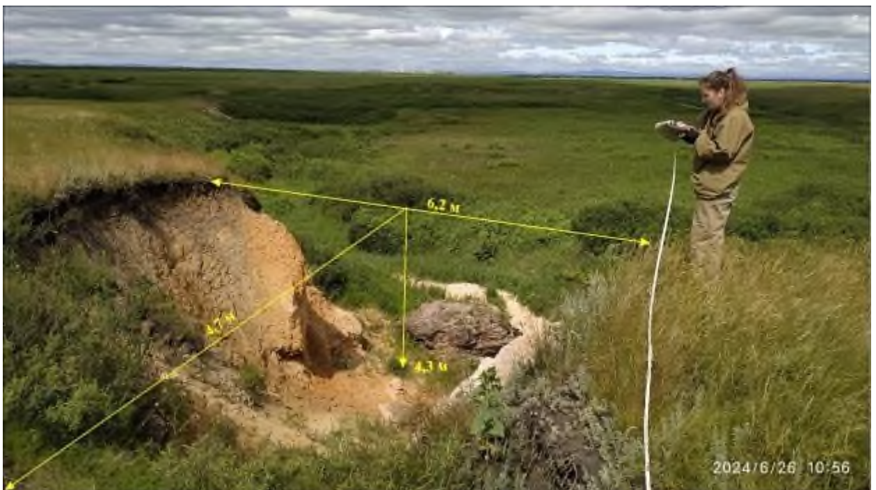
Фото 74-22-00198. Формирование овражка по левому борту оврага большой Лог в ТН 5. Янгельский участок Челябинская область
