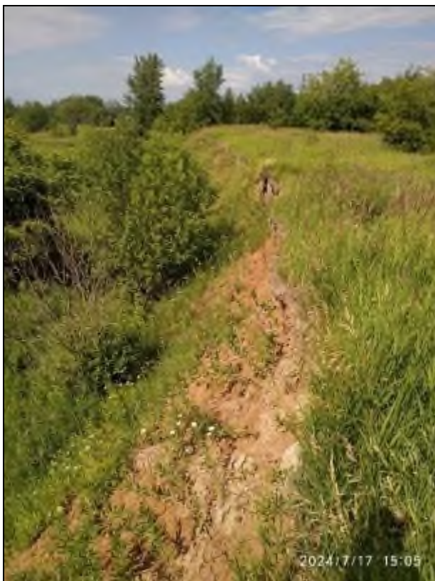
Фото 66-11-00555. Бровка отрыва оползневого блока на борту провала шахты Магнетитовая. Нижнетагильский участок Свердловская область
