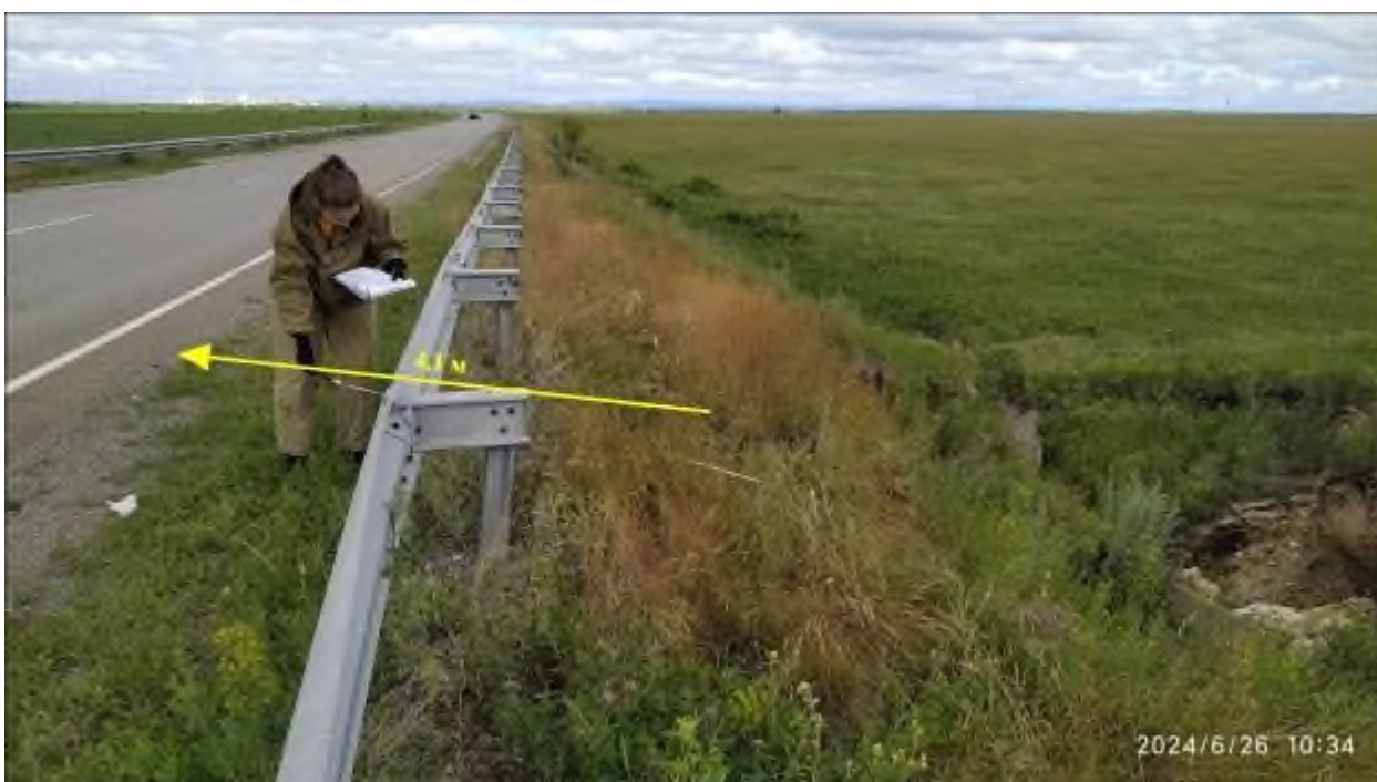
Фото 74-31-00171. Замер расстояния от левого борта оврага до края асфальта в ТН 4. Янгельский участок Челябинская область
