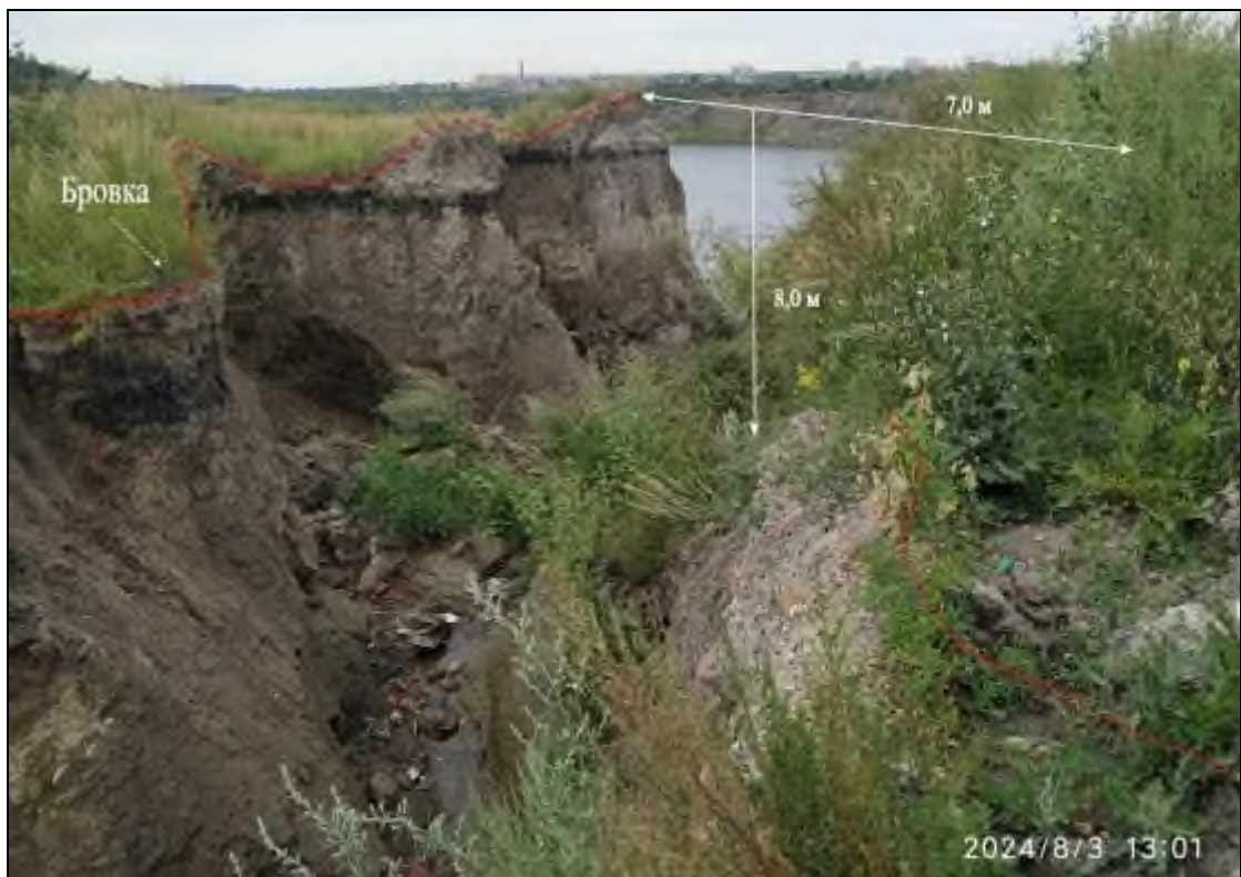
Фото 74-11-00068. Техногенная активизация процесса овражной эрозии в результате сброса канализационных вод в карьер. Копейский участок оперативного обследования, Челябинская область
