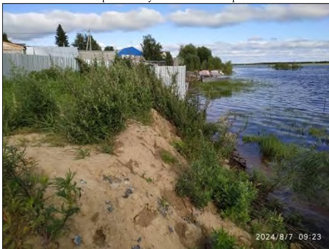
Фото 86-2024-01-001-12. Развитие гравитационного комплекса процессов на правом берегу ручья Гонченлор, в результате подрезки склона трассой ЛЭП в ТН 12. Березовский участок ХМАО-Югра
