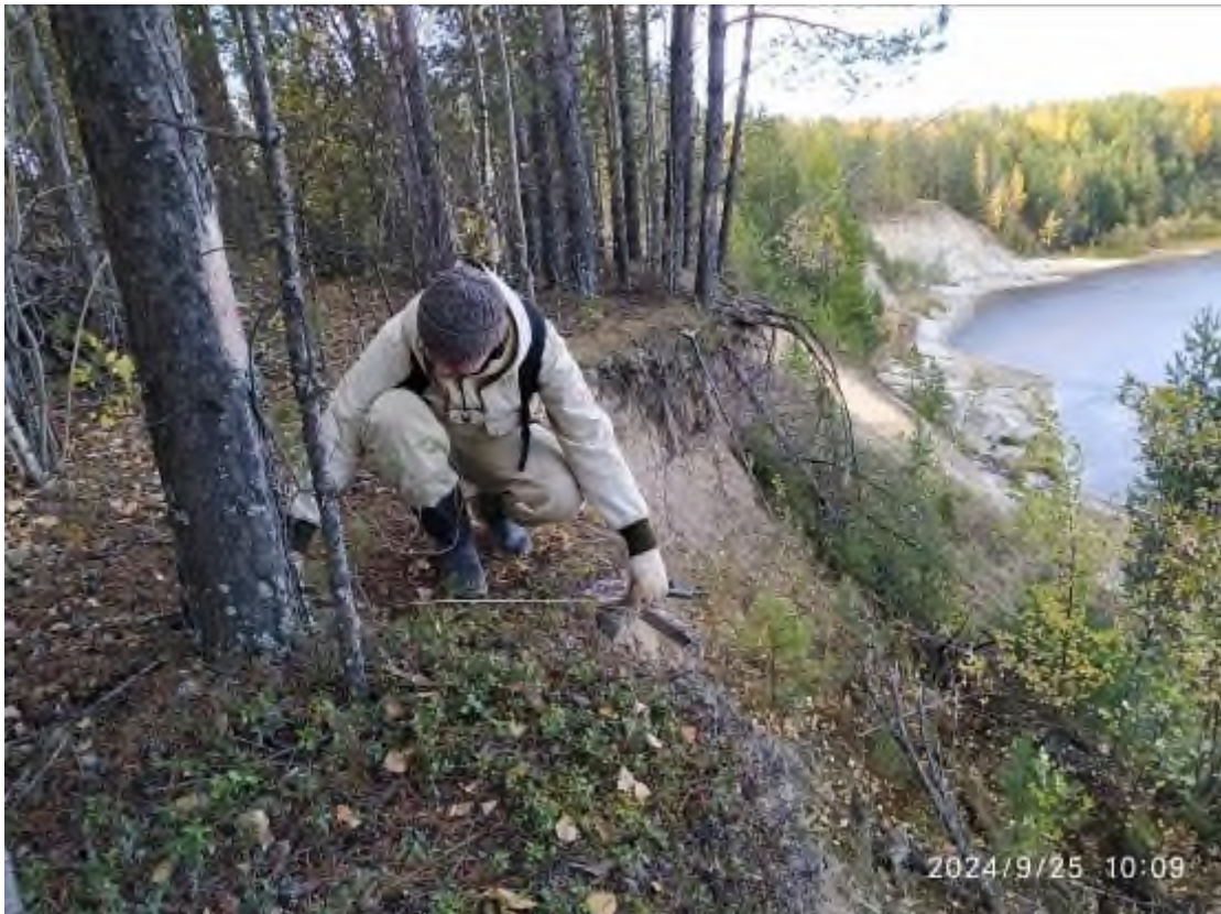
Фото 86-22-00126. Замеры расстояний от временных меток и грунтовой марки до бровки отрыва в ТН 6. Урайский участок ХМАО-Югра
