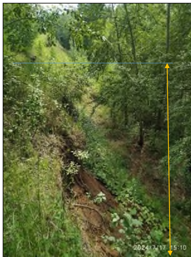
Фото 66-11-00555. Бровка отрыва оползневого блока на борту провала шахты Магнетитовая. Нижнетагильский участок Свердловская область
