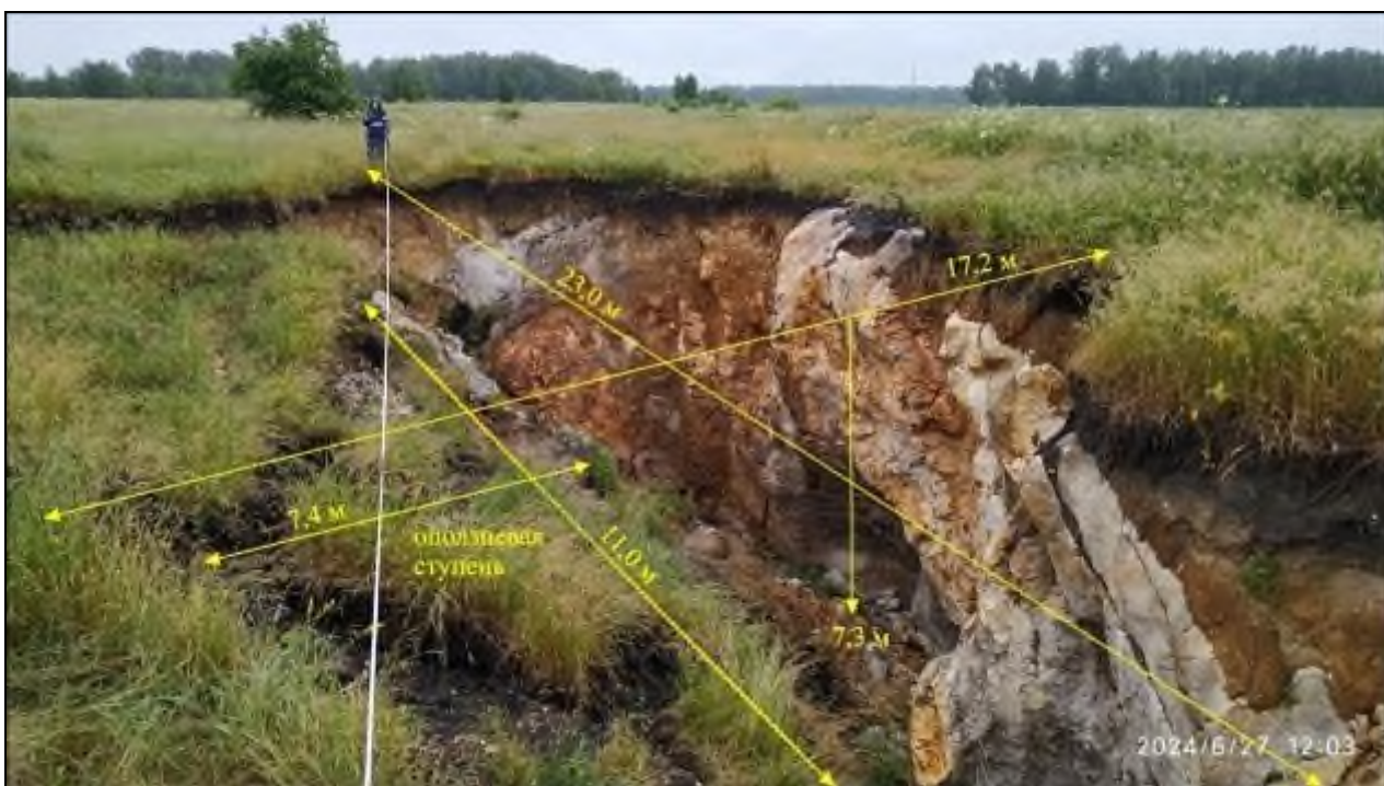
Фото 74-31-00227. Карстово-суффозионный провал в ТН 6. Красногорский участок Челябинская область
