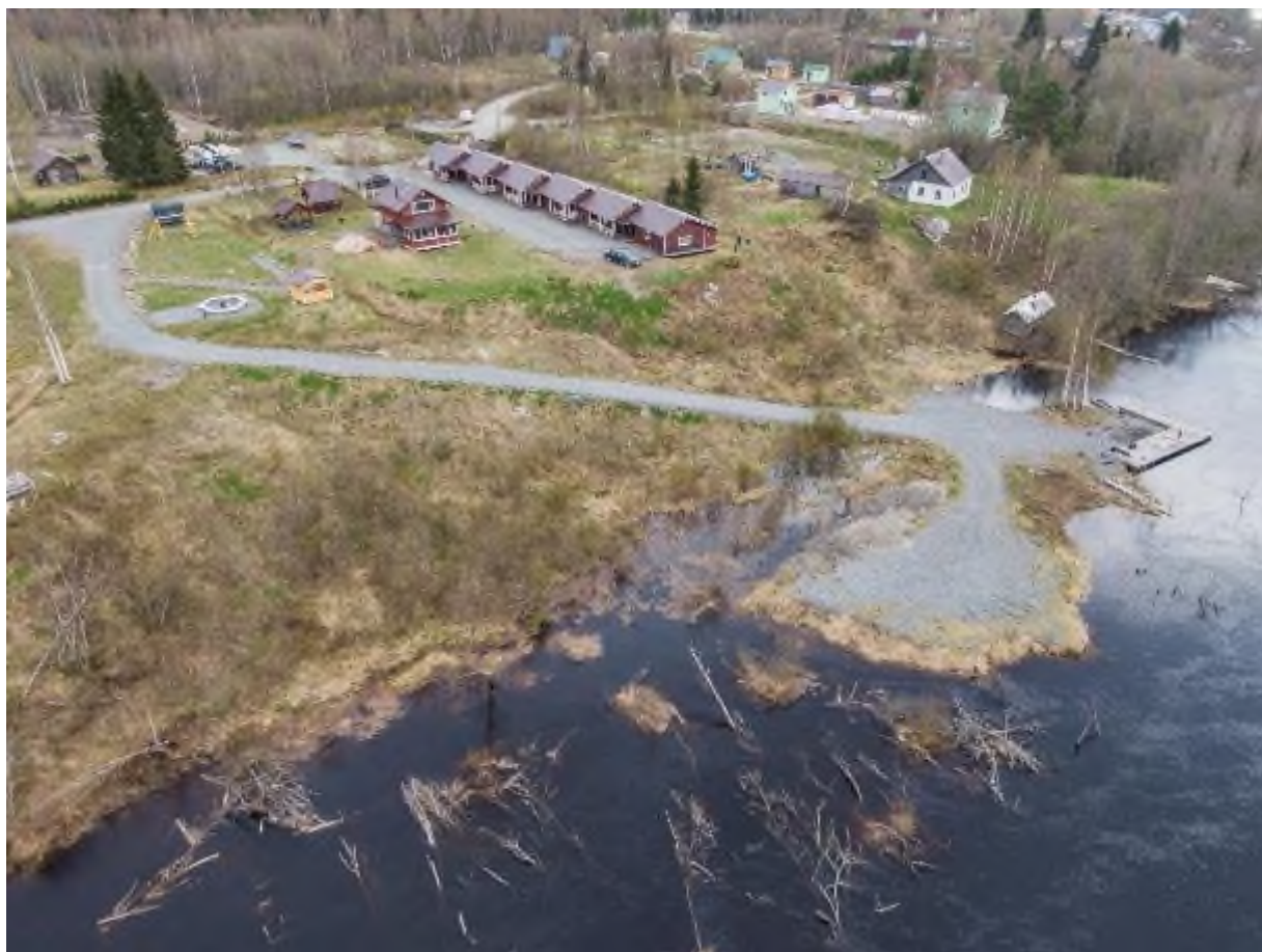
Фото 3. Поваленный сухостой на оползневом склоне, затопленная часть языка оползня вместе с засохшими деревьями в п. Хийденсельга
