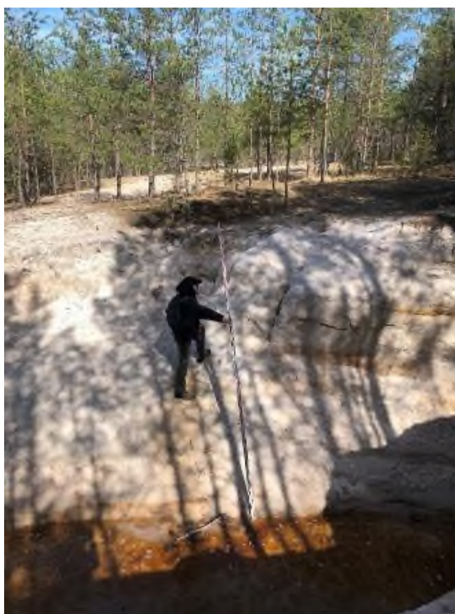
Фото 64. Свежие оползневые и осыпные массы на склоне и у подножья на участке обследования в 1,7 км на восток – северо-восток от п. Плоское, Талмачёвского ГП, Лужского района, Ленинградской области, 11.04.2024 г.
