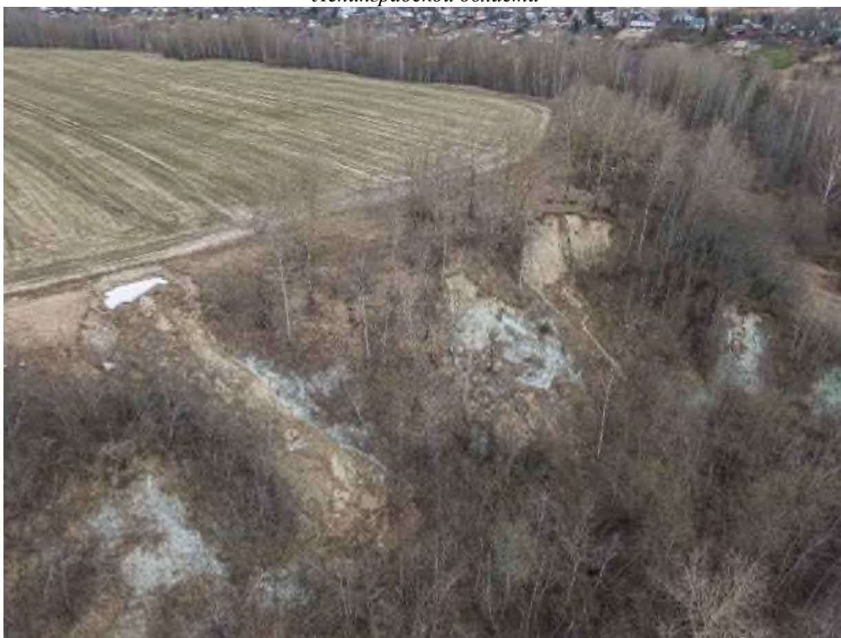
Фото 53. Воздействие оползневого процесса на сельскохозяйственные земли Никольского городского поселения Тосненского района Ленинградской области
