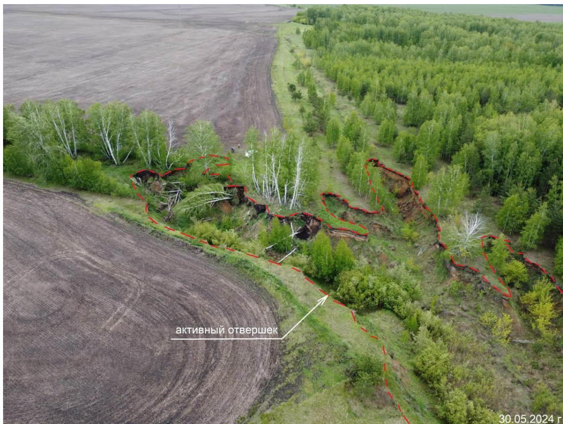
Фото 45-22-00006. Активный отвершек II порядка на Раскатихинском овраге. Раскатихинский участок, Притобольный район, Курганская область
