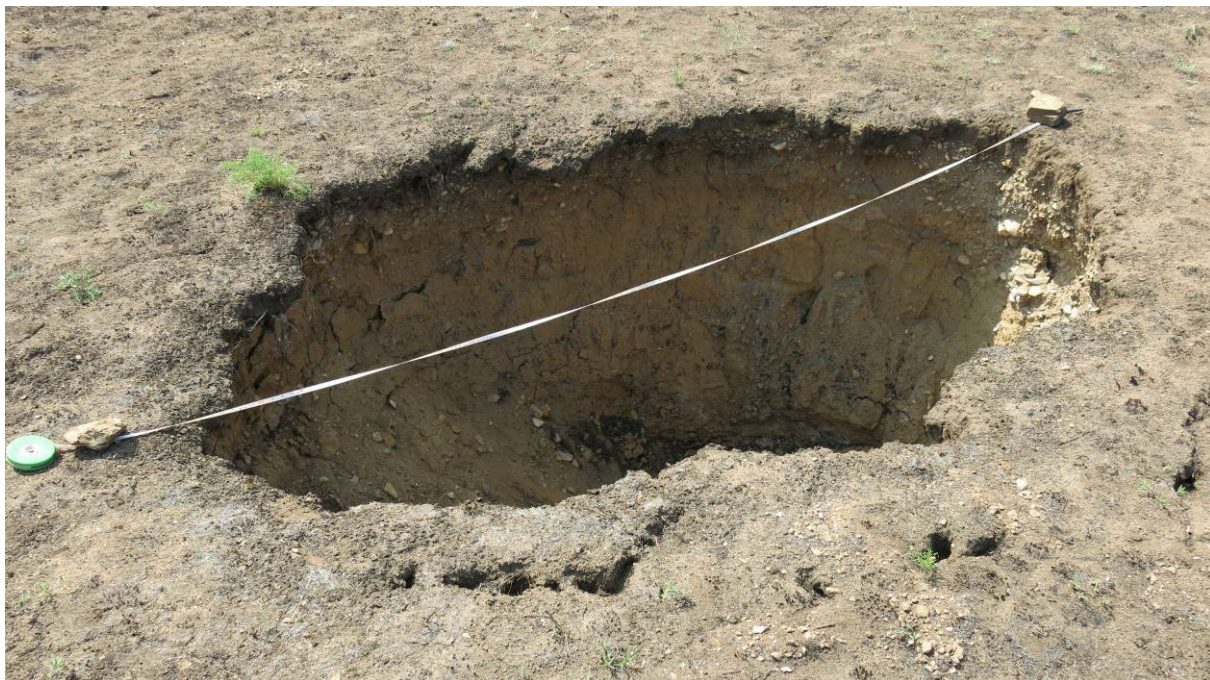
Фото 75-26-00002. Провал на Черновском шахтном поле, г. Чита, мкр. п. Рудник Кадала, Забайкальский край, 09.06.2025г.
