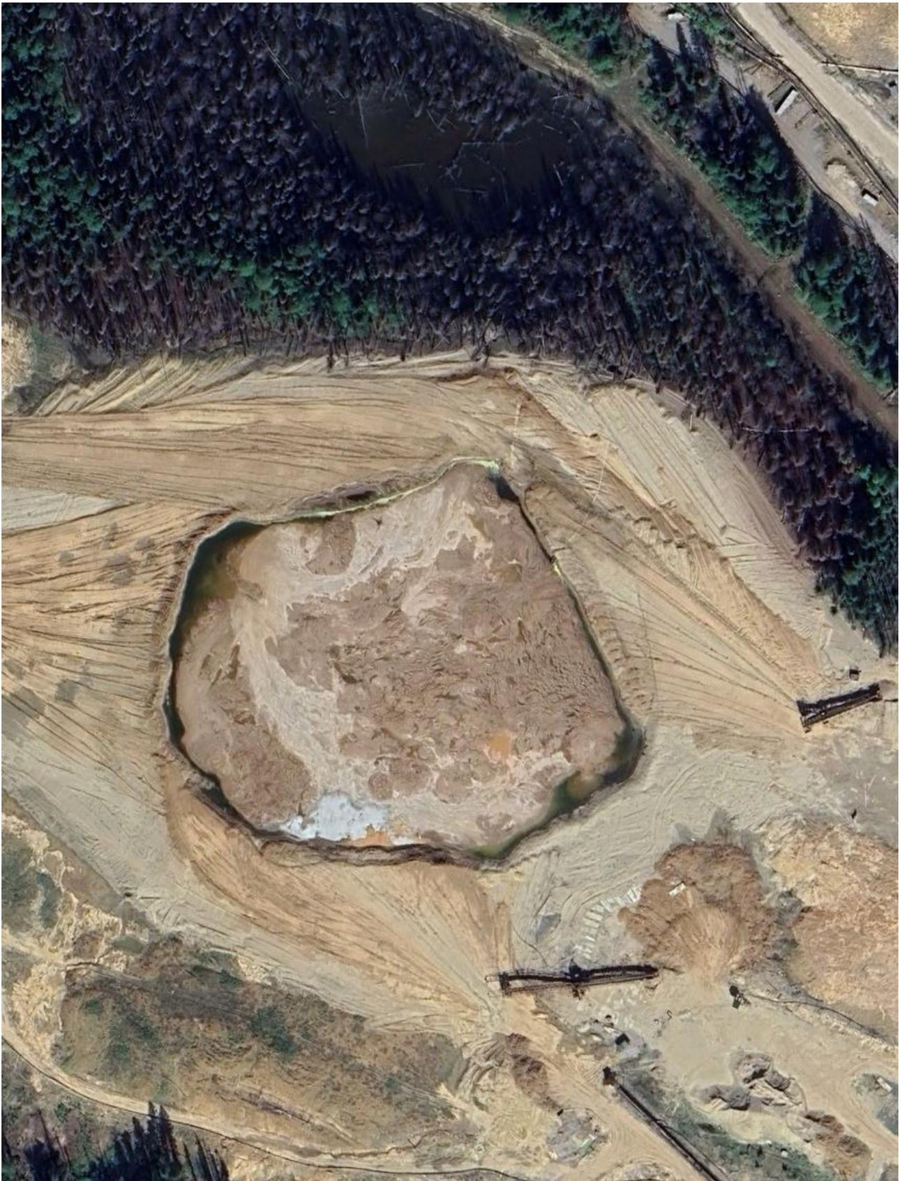
Фото 59-26-00010. Провал на аварийном участке СКРУ-2, июнь 2024 г., СНТ «Ключики», г. Соликамск, Пермский край.
