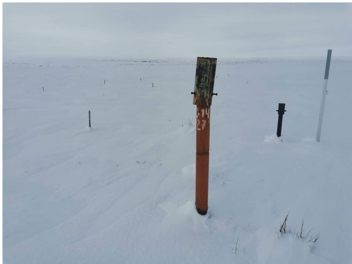
Фото 26. Скважина термометрическая ЗС-14/227, участок детальных наблюдений МГП 3
