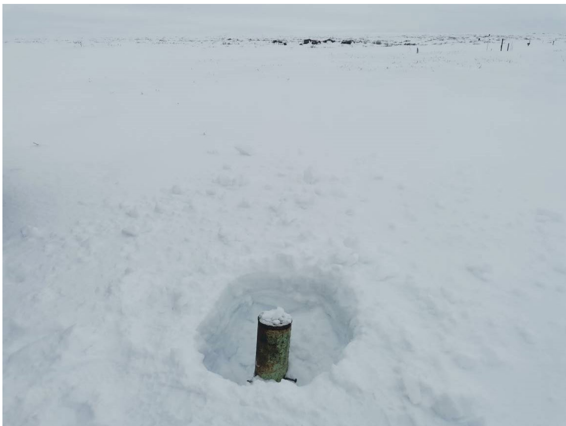
Фото 22. Скважина термометрическая ЗС-79, участок детальных наблюдений МГП 2
