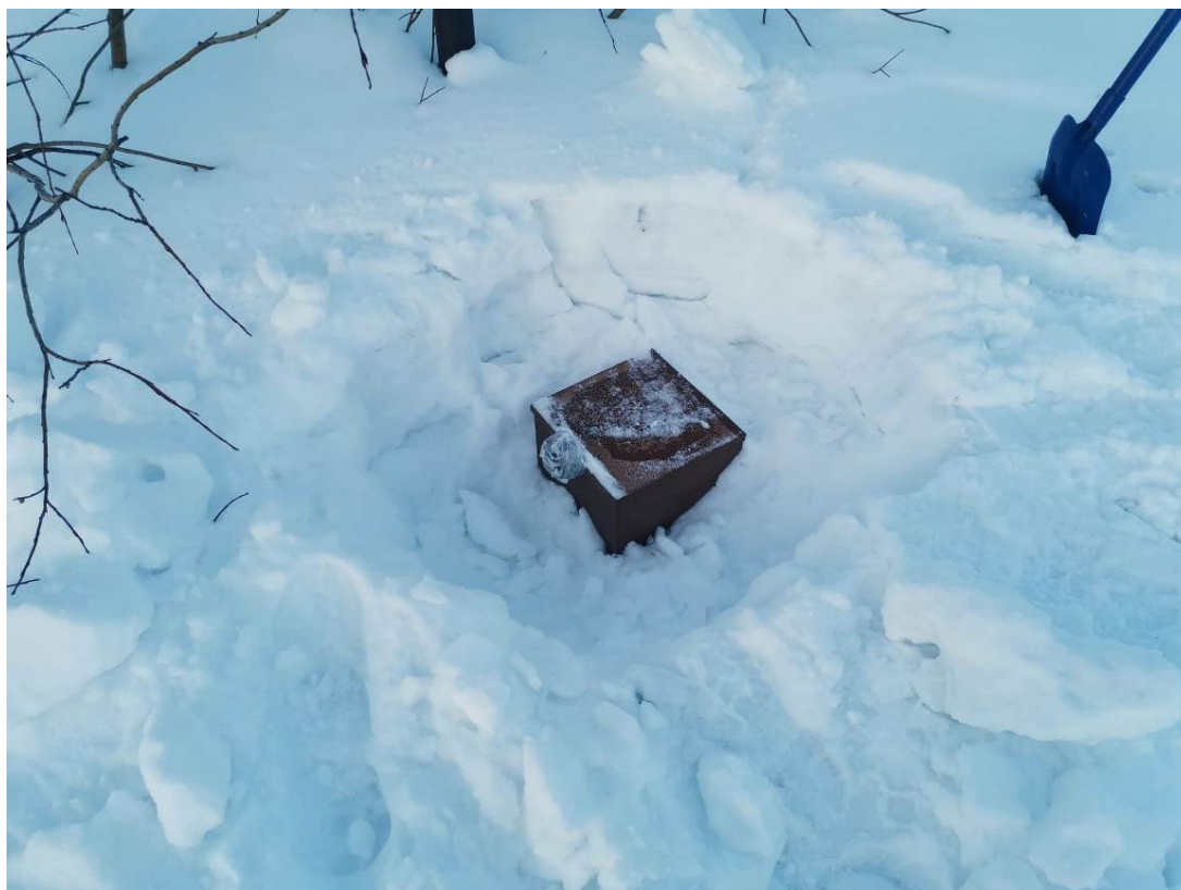
Фото 31. Скважина термометрическая Я-1бис, участок детальных наблюдений Восточно-Воркутский
