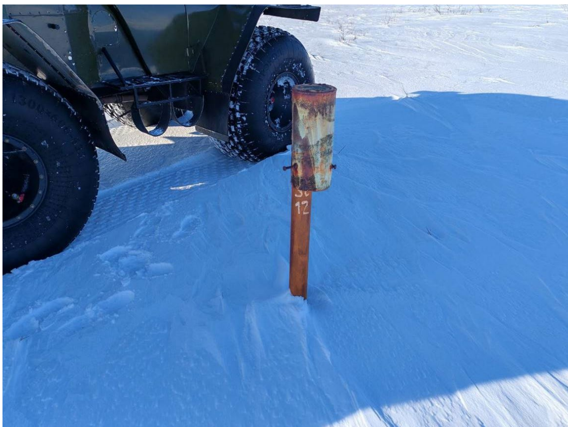
Фото 20. Скважина термометрическая ЗС-12, участок детальных наблюдений МГП I
