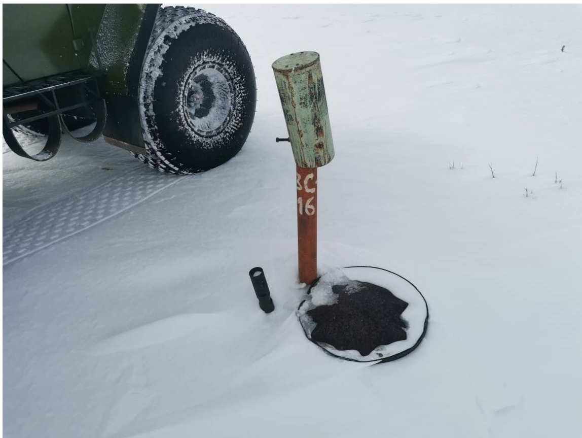
Фото 25. Скважина термометрическая ЗС-16, участок детальных наблюдений МГП 3
