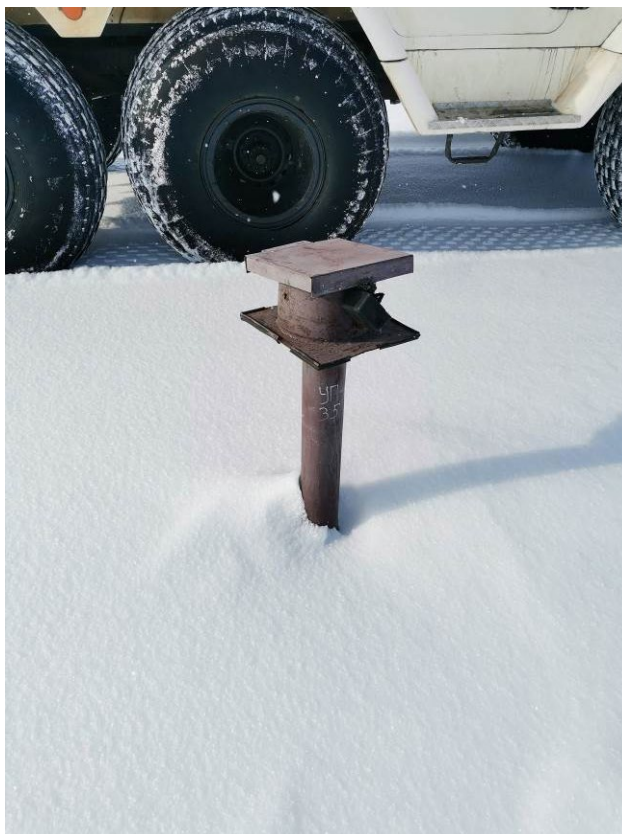
Фото 33. Скважина термометрическая УП-35, участок детальных наблюдений Усинское водохранилище 2
