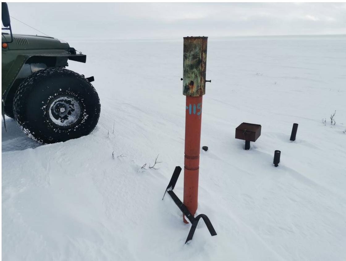
Фото 27. Скважина термометрическая ЗС-115, участок детальных наблюдений Лек-Воркутский 1
