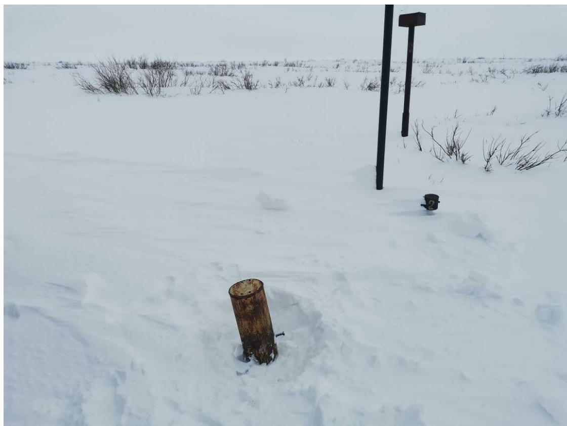
Фото 28. Скважина термометрическая ЗС-83а, участок детальных наблюдений Лек-Воркутский 1
