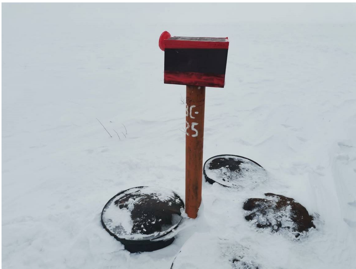
Фото 21. Скважина термометрическая ЗС-25, участок детальных наблюдений МГП 1
