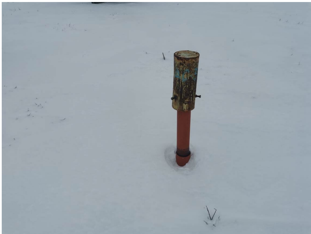
Фото 29. Скважина термометрическая ДС-3/ВП-74, участок детальных наблюдений Лек-Воркутский 2
