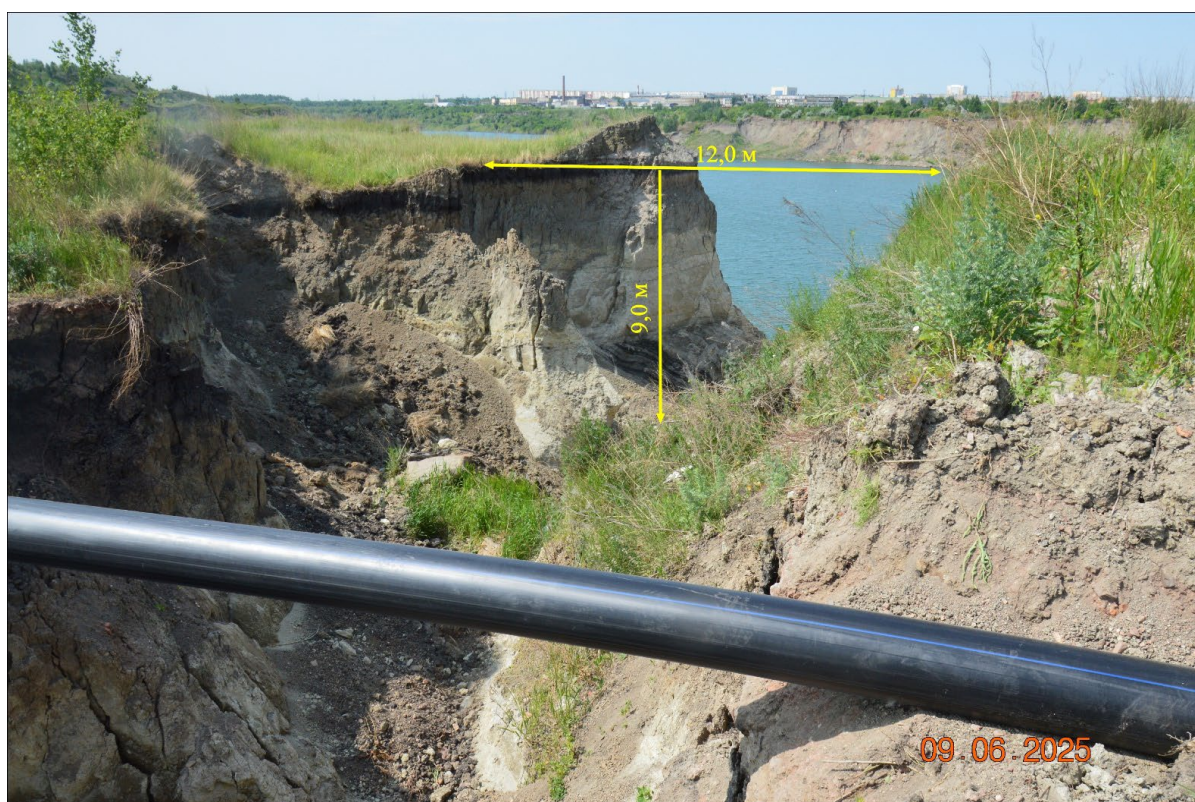
Фото 74-22-00263. Канавы № 1. Техногенная активизация процесса овражной эрозии в результате сброса канализационных вод в карьер. Копейский участок оперативного обследования, г. Копейск, Челябинская область
