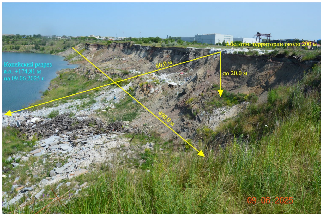
Фото 74-11-00068. Обрушение борта карьера в ТН 13. Копейский участок оперативного обследования, г. Копейск, Челябинская область
