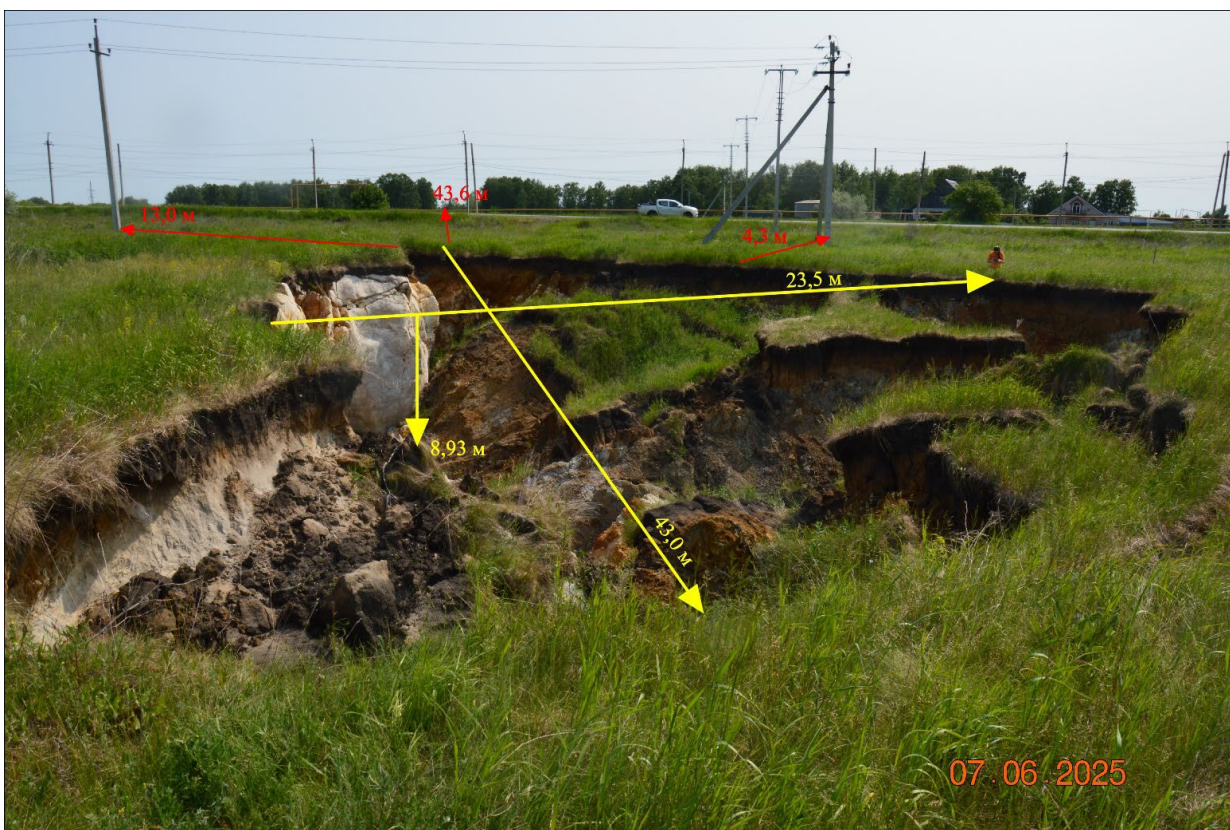
Фото 74-31-00227. Карстово-суффозионный провал в ТН 6. Красногорский пункт наблюдений. Челябинская область
