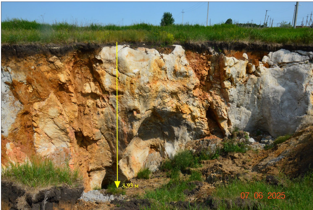
Фото 74-31-00227. Геологический разрез на борту карстового провала в ТН 6. Красногорский пункт наблюдений. Челябинская область
