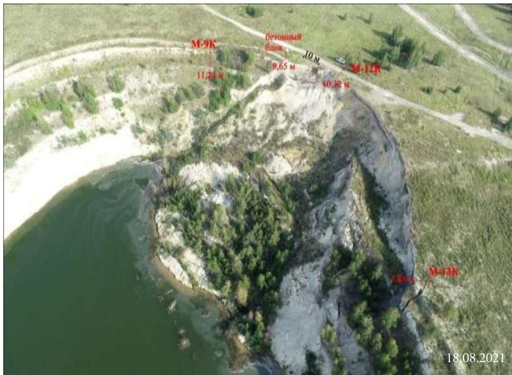
Рис. 2.81. Общий вид оползня в ТН 25 на Копейском-1 участке.
