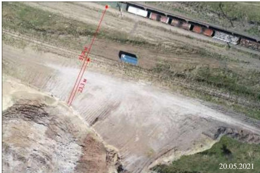
Рис. 2.77. Результаты замеров расстояния до ж/д линии от бровки отрыва оползня
