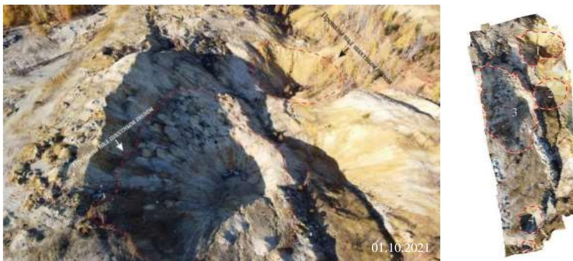
Рис. 2.57. Провалы над старыми горными выработками на восточной окраине пос. Левиха Кировградского ГО Свердловская область (слева – снимок с БВС, справа – ортофотоплан участка)
