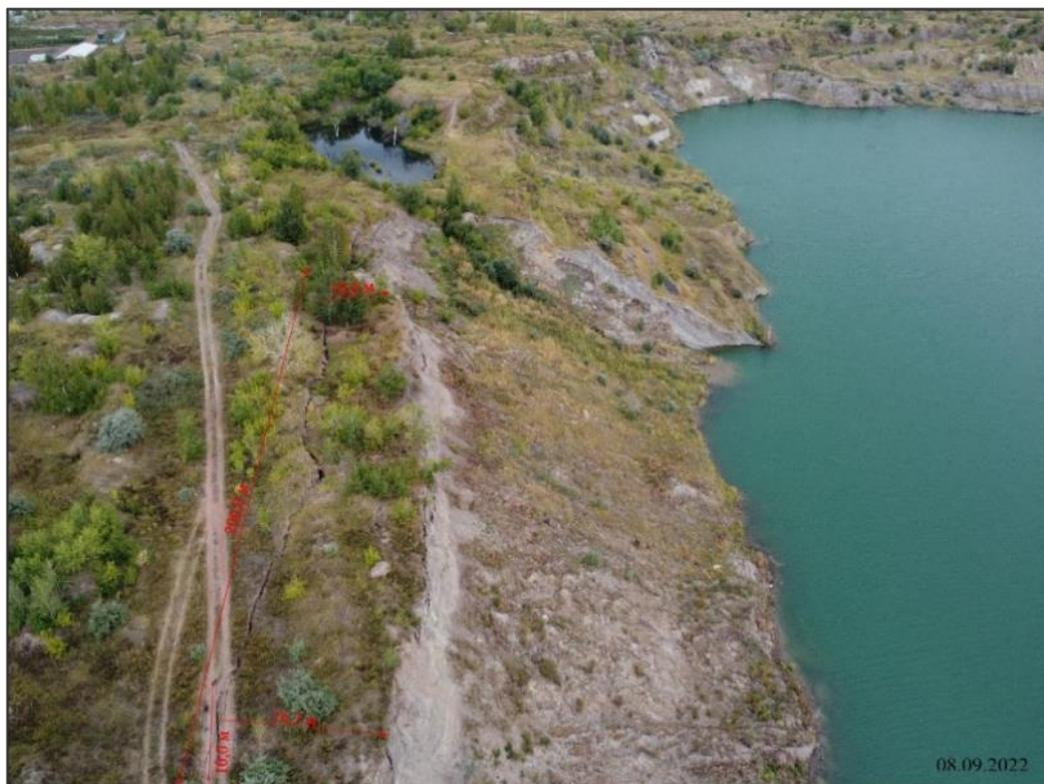
Рис. 2.67. Формирование оползневого блока и трещина отрыва на западном борту Копейского разреза (ТН 12). Копейский-1 участок Челябинская область
