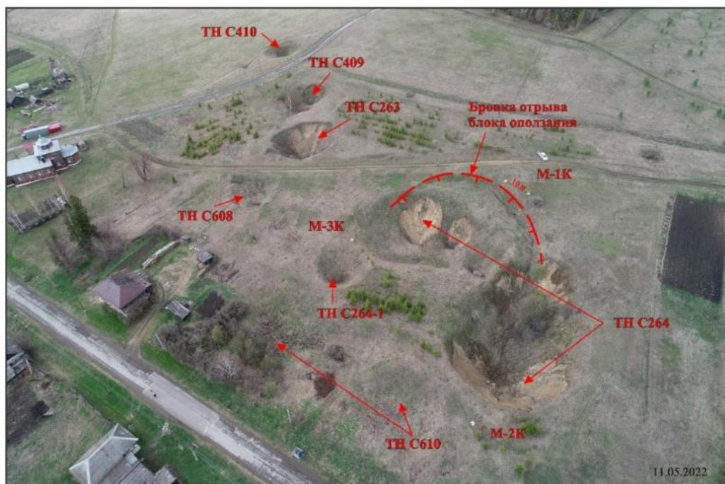
Рис. 2.40. Схема расположения воронок в южной части участка Красноуфимский, Свердловская область
