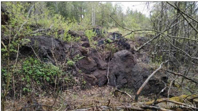
Рис. 2.63. Вал выпирания в ТН 3, состоящий из торфяных блоков. Катав-Ивановский участок, Челябинская область
