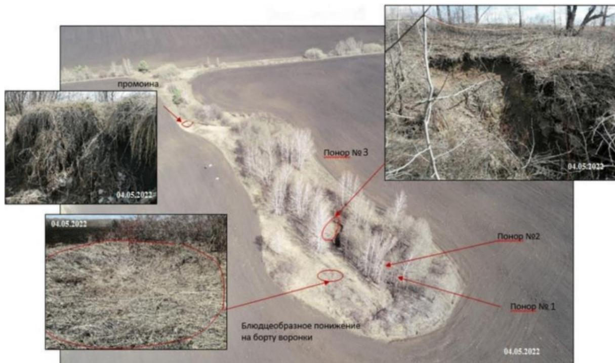
Рис. 2.36. Карстово-суффозионная воронка в ТН С145.
