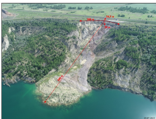
Рис. 2.2.125. Оползень-поток на восточном борту затапливаемого угольного разреза. Западная окраина пос. Красногорский, Еманжелинский район, Челябинская область
