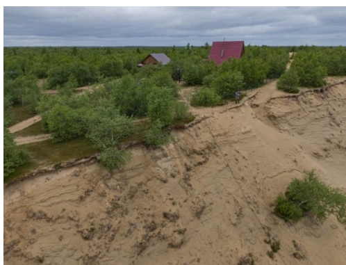
Рис. 2.2.31. Оползневой склон вдоль левого берега реки Куя, в районе рп. Искателей, Ненецкий АО
