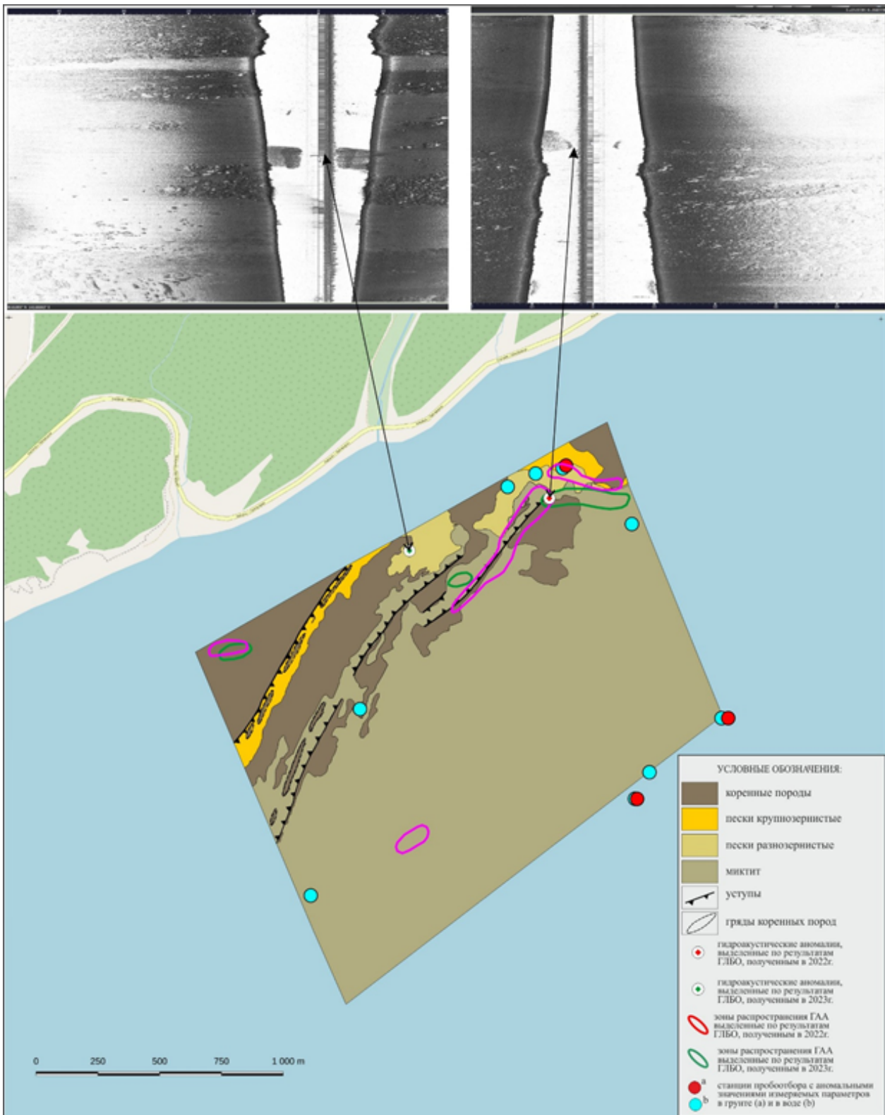
Рис. 3.32 Распределение зон проявления гидроакустических аномалий на участке Пригородное
