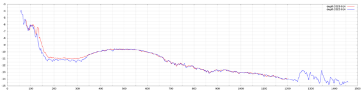
Рис. 3.10. Графики глубин по профилю 014, пересекающему зону развития гравитационных процессов. Участок «Восточное», 2022 и 2023 гг.
