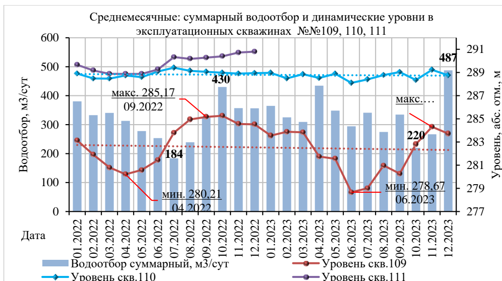
Рис. 1.68. Изменение суммарного водоотбора и уровней в эксплуатационных скважинах на участке "Улунгинский" АО "Покровский рудник" за 2022 - 2023 гг. ВЗТ раннемеловых интрузивных пород
