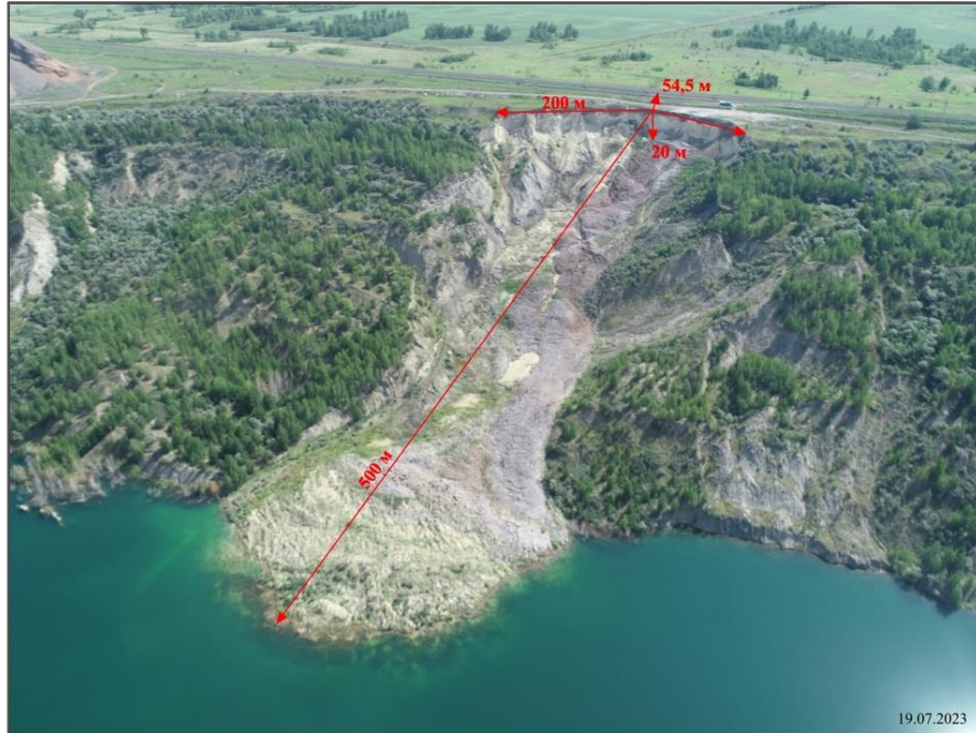
Рис. 2.49. Крупный оползень-поток на восточном борту затопляемого угольного разреза (ТН 2). Красногорский участок, Челябинская область
