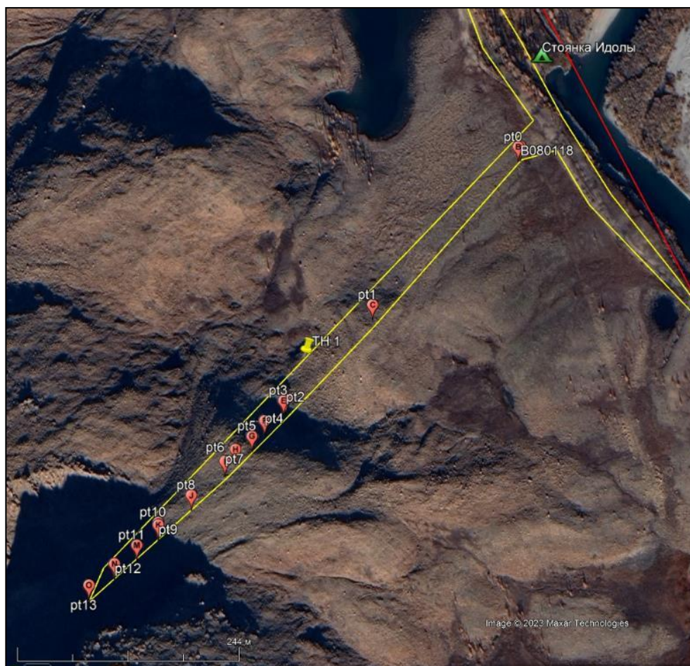
Рис. 2.58. Схема профиля и точек наблюдений за осыпным процессом. Участок «Массив Рай-Из», ЯНАО
