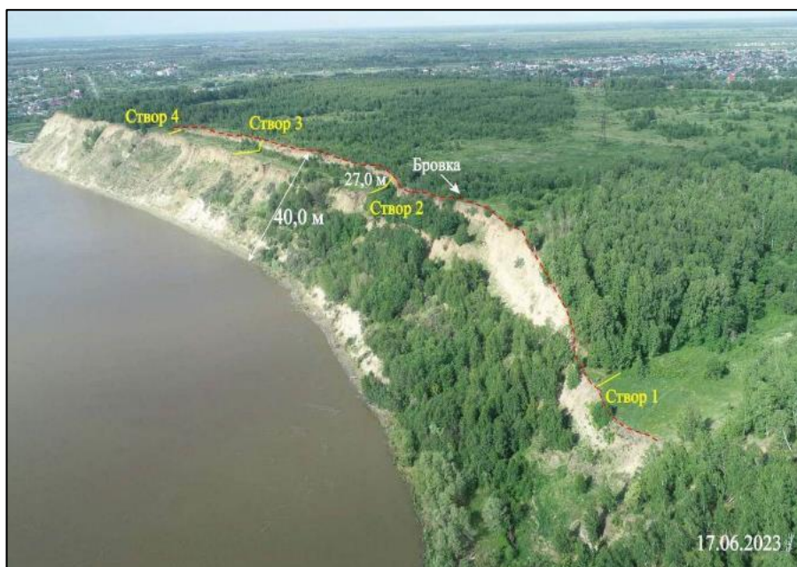
Рис. 2.35. Участок развития гравитационного комплекса процессов на высоком берегу р. Иртыш. Тобольский участок, Тюменская область
