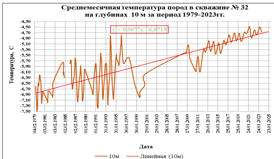
Рис. 2.66. Изменение среднегодовой температуры пород на глубине 10 м в скв. 32 за период 1979-2023 гг. Марре-Сале, ЯНАО
