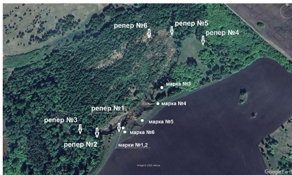
Рис. 2.2.114. Схема расположения реперной сети на оползневом участке Нечунаевский, Курганская область
