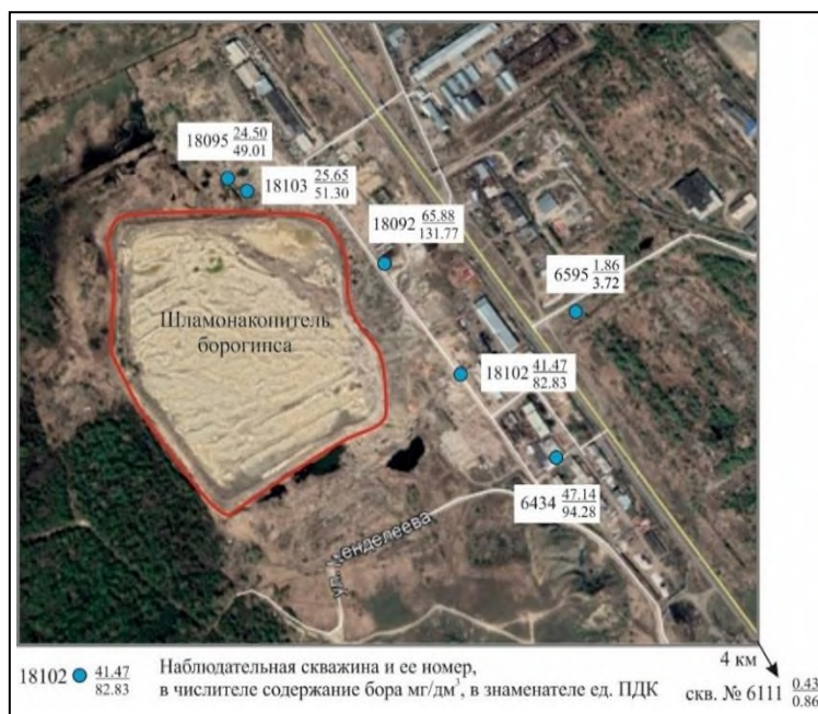
Рис. 1.4.47. Участок загрязнения подземных вод бором в г Комсомольске-на-Амуре в 2024 г.
