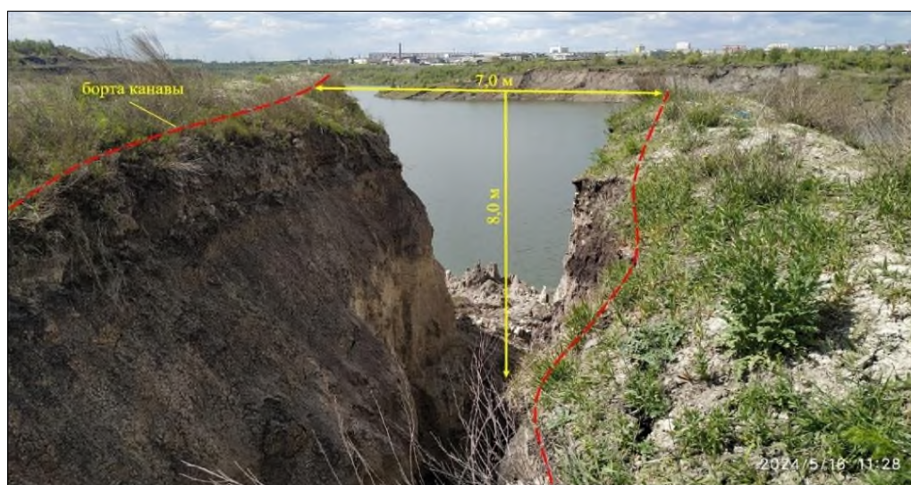
Рис. 2.2.149. Активизация процесса овражной эрозии на участке сброса сточных вод в Копейский разрез (ТН 13). Копейский участок, Челябинская область
