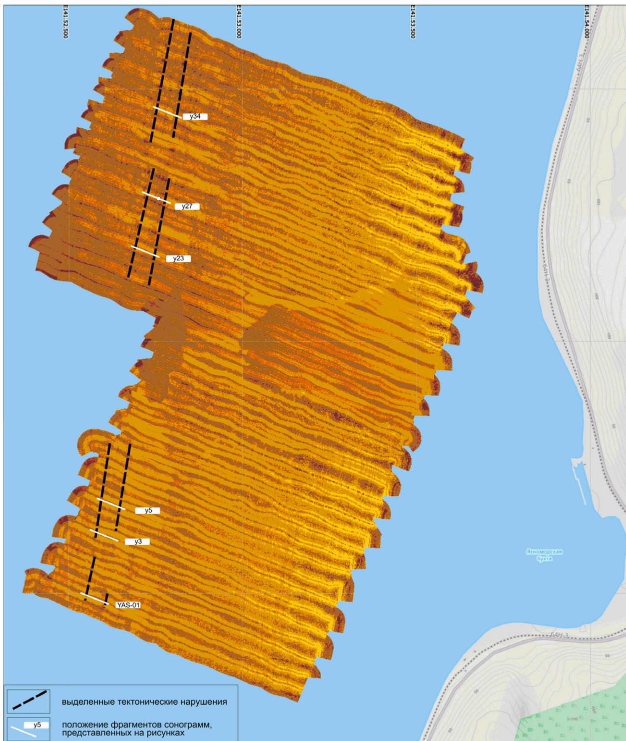
Рис. 3.5. Отображение подводных уступов на мозаике гидролокации бокового обзора. Участок «Ясноморское»
