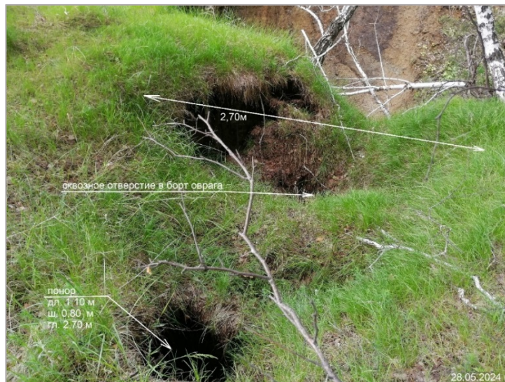
Рис. 2.25. Суффозионная воронка в ТН № 45-17-00167. Участок Нечунаевский, Курганская область
