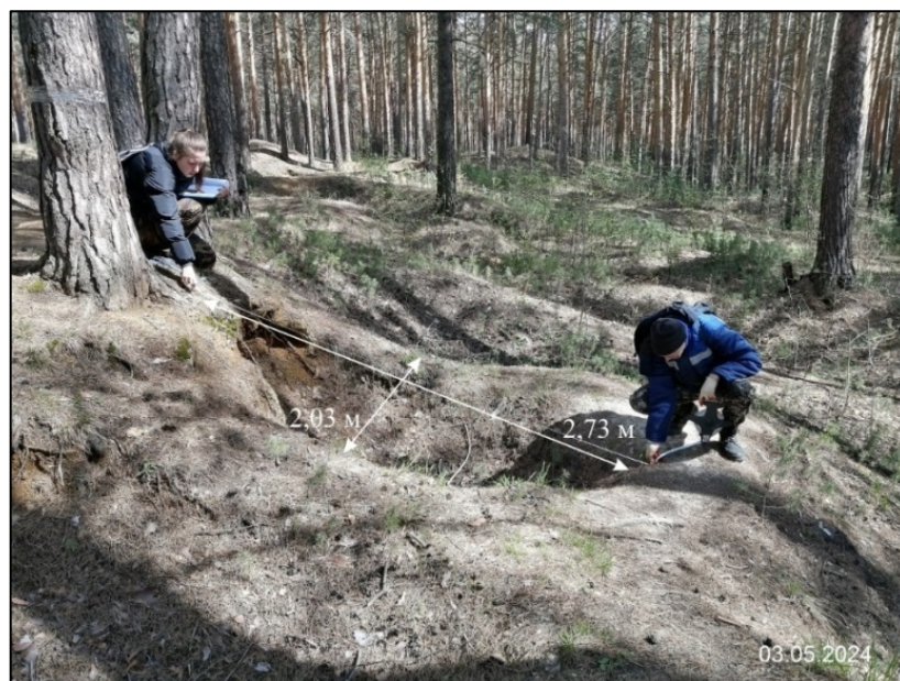
Рис. 2.33. Карстово-суффозионная воронка в ТН С524. Участок Каменский, Свердловская область
