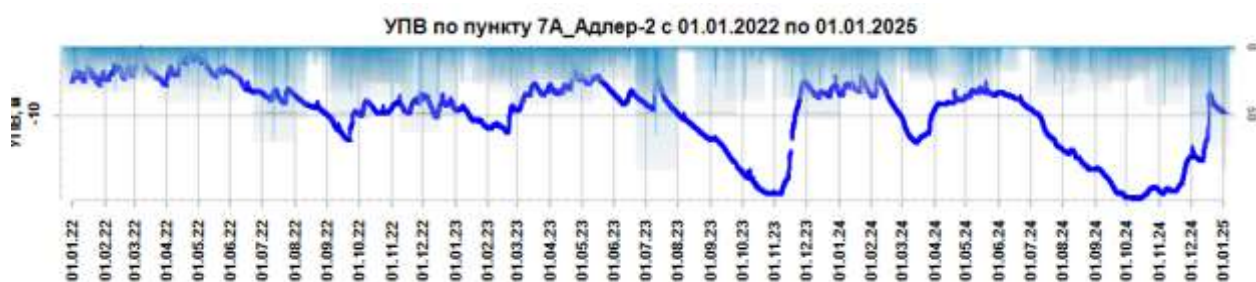
Рис. 1.28. Уровень подземных вод в 2022-2024 гг. на Левобережном водозаборе Адлерского участка Нижнезымтинского МПВ
