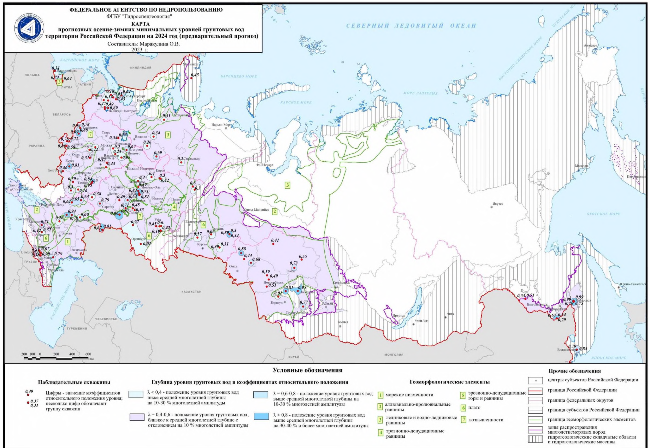
Рис. 5. Карта прогнозных осенне-зимних минимальных уровней грунтовых вод территории Российской Федерации на 2024 год (предварительный прогноз)
